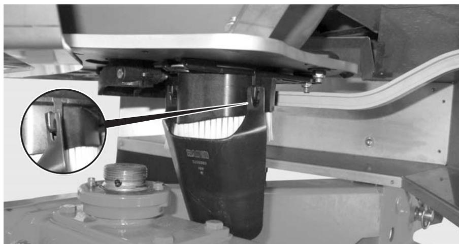
Imagen 12: Enganchar el plano inclinado de prueba de giro
