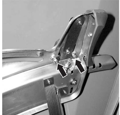
**Imagen 25:** Soltar la chapa de ajuste del punto de salida
