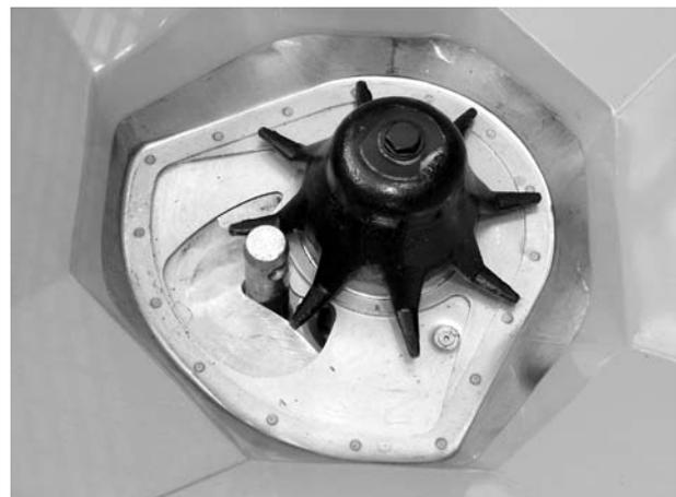
**Imagen 23:** Perno de brazo inferior en el orificio de dosificación
