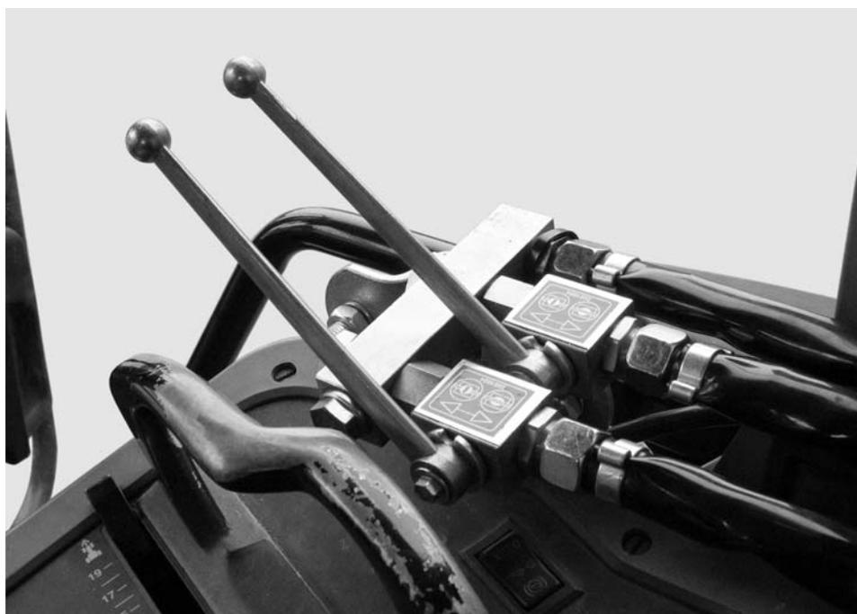
**Imagen 1:** Accionamiento de correderas de la unidad de dos vías
