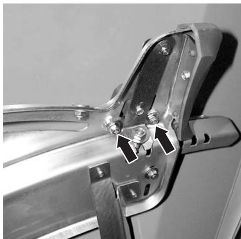
**Imagen 29:** Soltar la chapa de ajuste del punto de salida
