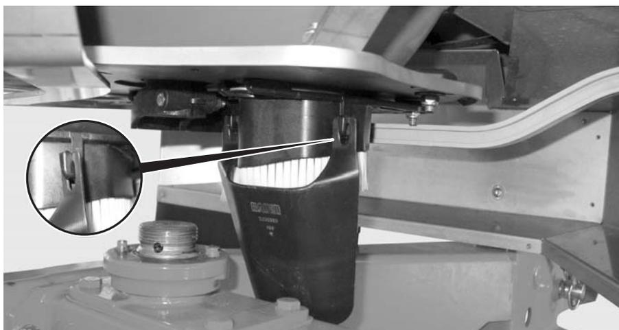
Imagen 11: Enganchar el plano inclinado de prueba de giro
