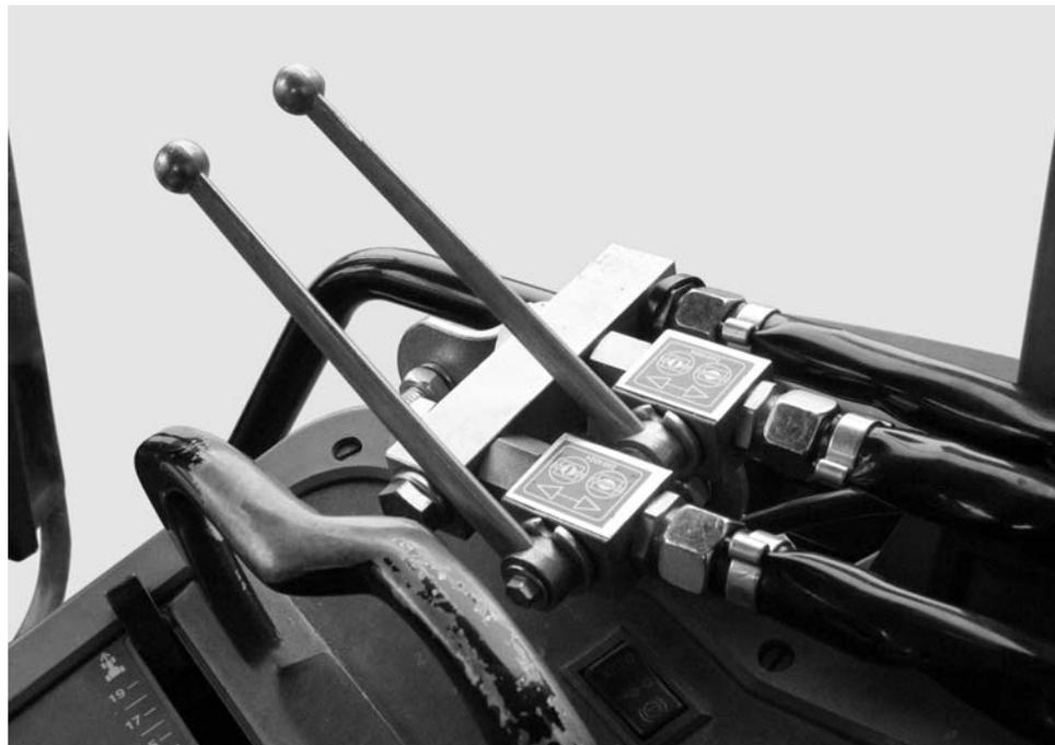
**Imagen 8:** Accionamiento de correderas de la unidad de dos vías
