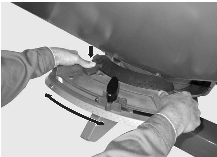
**Imagen 13:** Centro de ajuste punto de salida
