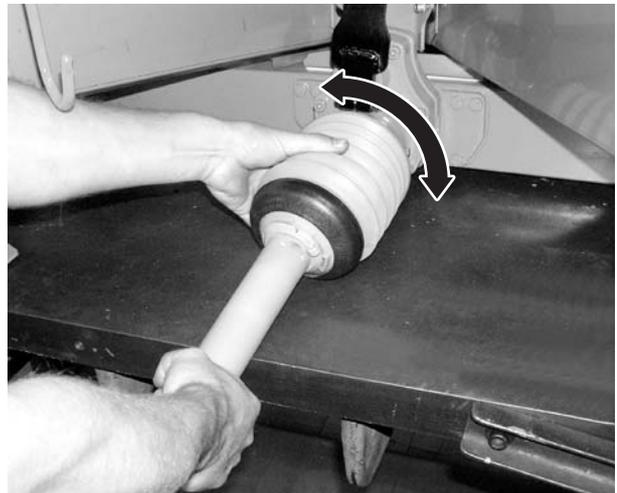
Imagen 8.4: Colocar la protección del eje articulado
