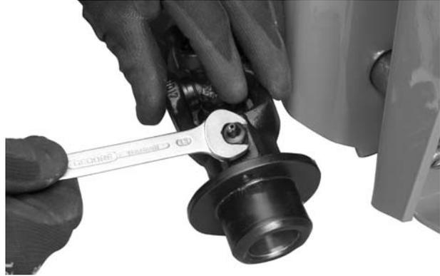
Imagen 2: Soltar boquilla de lubricación
