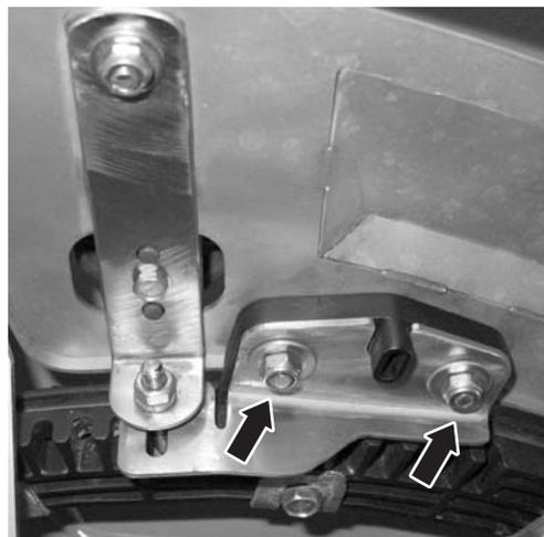
**Figura 28:** Staccare il pannello di taratura del punto di applicazione
