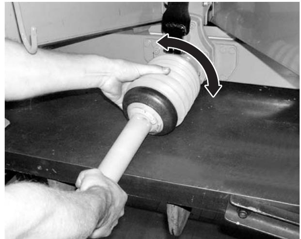
**Figura 6:** Posizionare la protezione dell'albero cardanico
