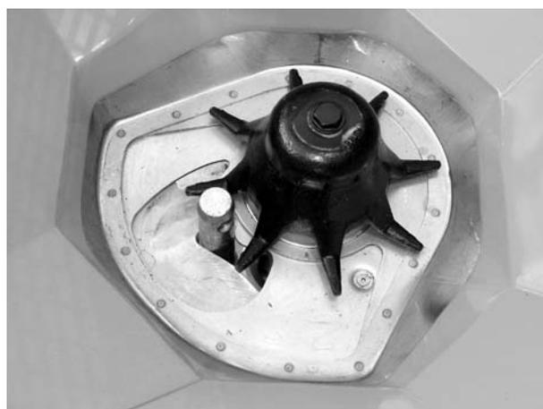
**Figura 22:** Perno del braccio inferiore nell'apertura di dosaggio
