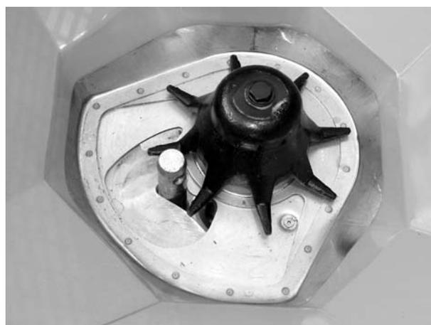
**Figura 23:** Perno del braccio inferiore nell'apertura di dosaggio
