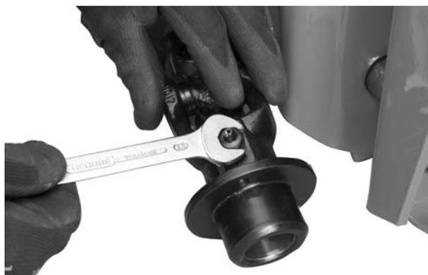
**Figura 2:** Svitare il raccordo per lubrificazione
