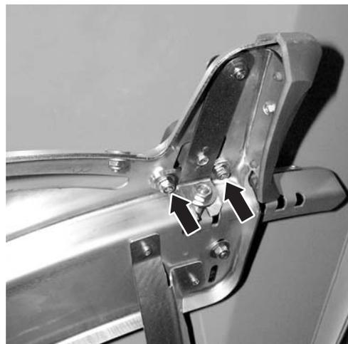
**Figura 25:** Staccare il pannello di taratura del punto di applicazione
