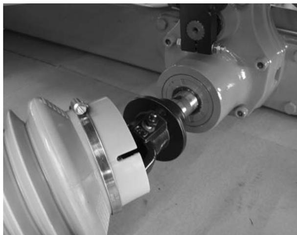
**Figura 3:** Infilare l'albero cardanico sul perno del cambio
