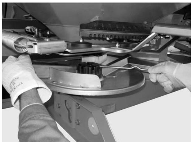
**Figure 4:** Loosen the cap nut
