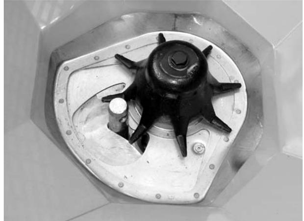
Figure 22 : Axe du bras inférieur dans la trappe
