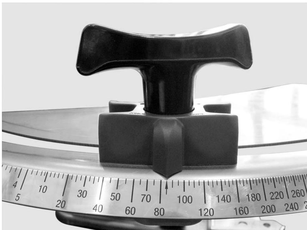
**Figure 23 :** Secteur gradué des vannes de dosage
