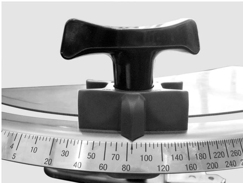
**Figure 24 :** Secteur de réglage des vannes de dosage
