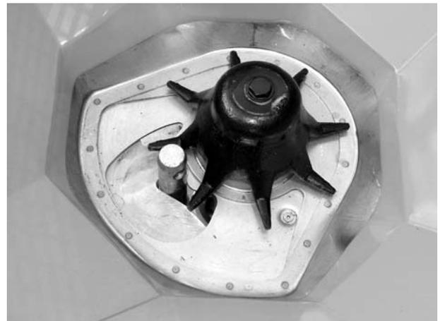
**Figure 23 :** Écrou du bras inférieur dans la trappe
