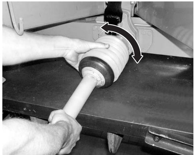
**Figure 8.4 :** Installer la protection de l'arbre de transmission
