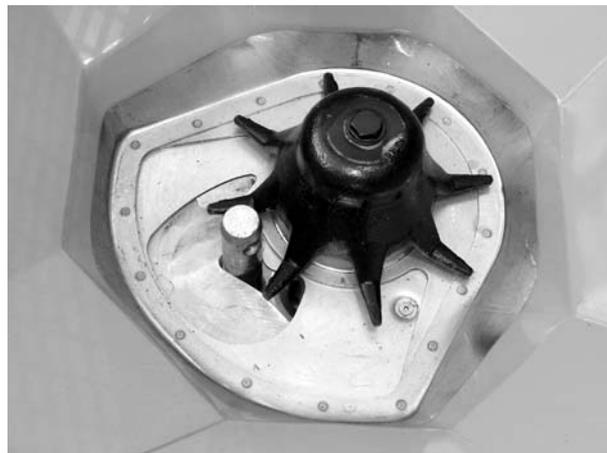
1. Prendre un axe de bras inférieur d'un diamètre de **28 mm** et le placer au centre de la trappe.
