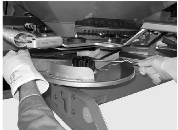
1. Com a alavanca de ajuste soltar a porca de capa. Retire o disco dispersor do cubo.
