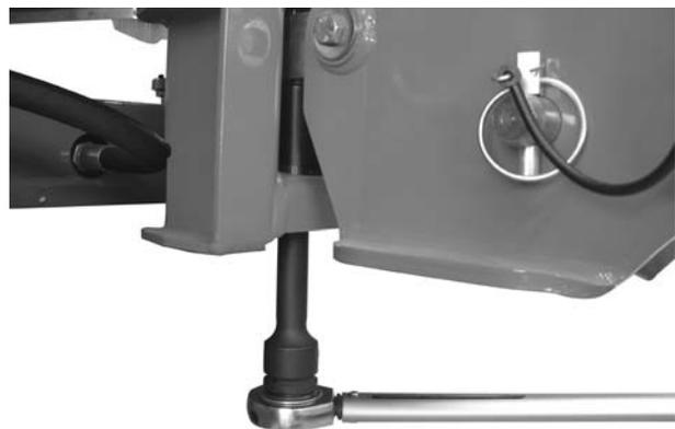
**Imagem 18:** Fixação da célula de pesagem (em direcção do trajecto à esquerda)
