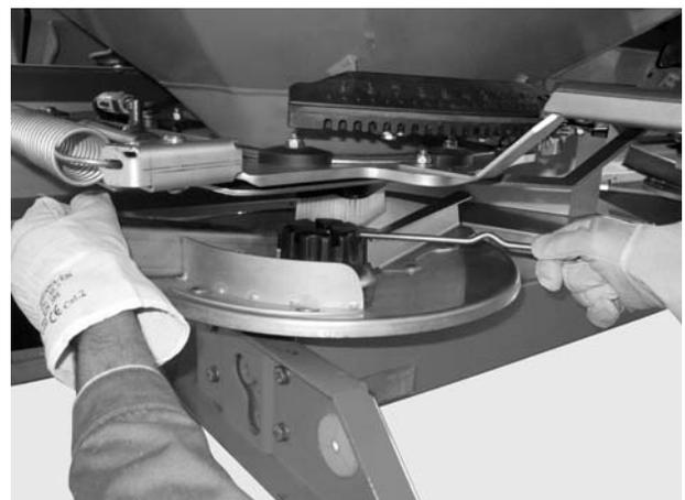
1. Com a alavanca de ajuste soltar a porca de capa. Remover os discos dispersores do cubo.
