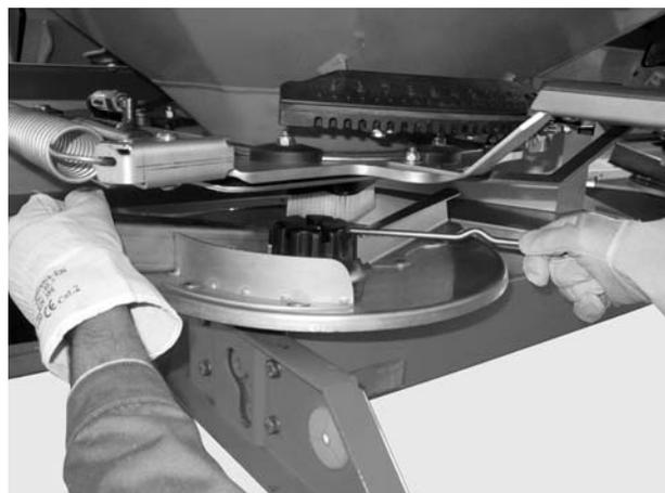
1. Remover a alavanca de ajuste do suporte.
