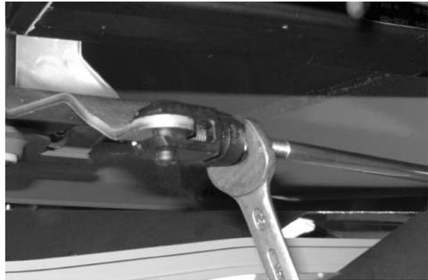
Imagem 29: Suspender a cabeça da forquilha interior
