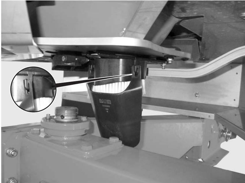
Imagem 12: Suspender o deslizador do teste de rotação
