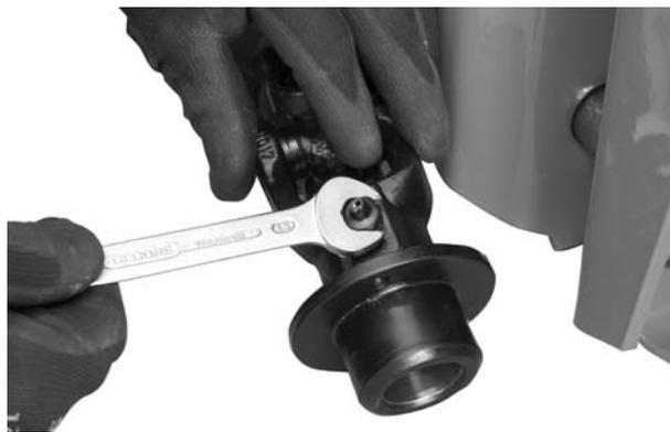
Imagem 2: Soltar o bocal de lubrificação
