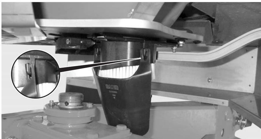
**Imagem 19:** Suspender o deslizador do teste de rotação
