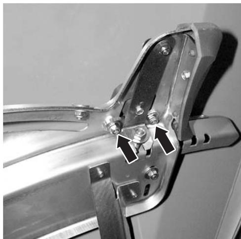
**Imagem 25:** Remover a chapa de ajuste do ponto de saída
