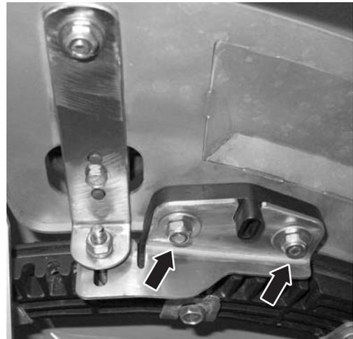
**Imagem 28:** Remover a chapa de ajuste do ponto de saída
