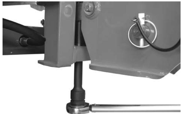
**Figure 9.1 :** Fixation de la cellule de pesage (à gauche dans le sens d'avancement)
