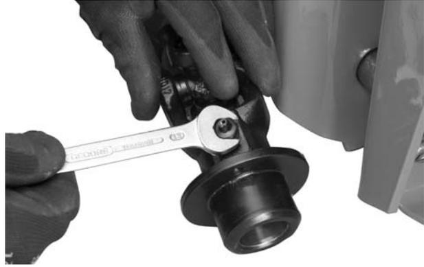
**Figura 2:** Svitare il raccordo per lubrificazione
