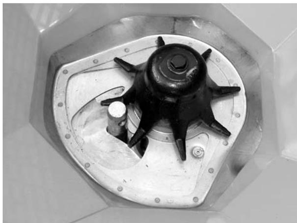
1. Togliere un perno del braccio inferiore  $d = 28 \text{ mm}$  e infilarlo al centro dell'apertura di dosaggio.
