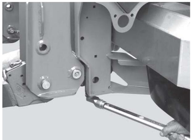
**Figura 23:** Fissaggio della cella di taratura (a sinistra, nel senso di marcia)
