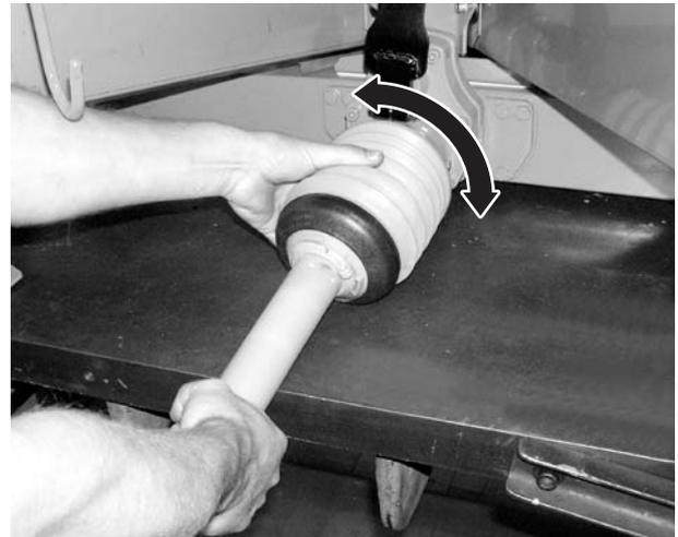
**Figura 6:** Posizionare la protezione dell'albero cardanico
