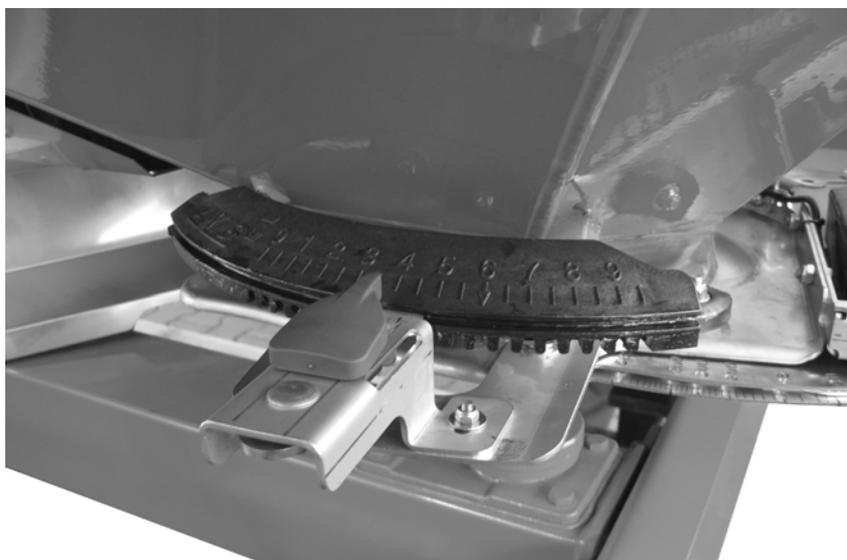
**Figura 6:** Indicatore per il punto di applicazione
