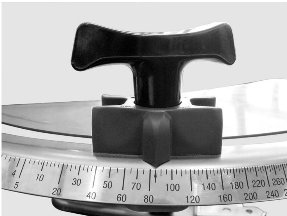
**Figura 23:** Scala per la regolazione dei dosatori
