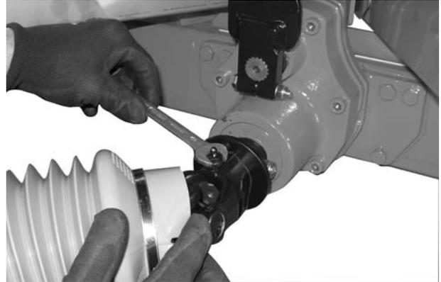
**Figura 5:** Riavvitare il raccordo per lubrificazione
