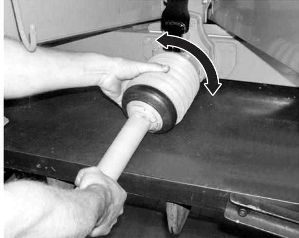
**Figura 8.4:** Posizionare la protezione dell'albero cardanico
