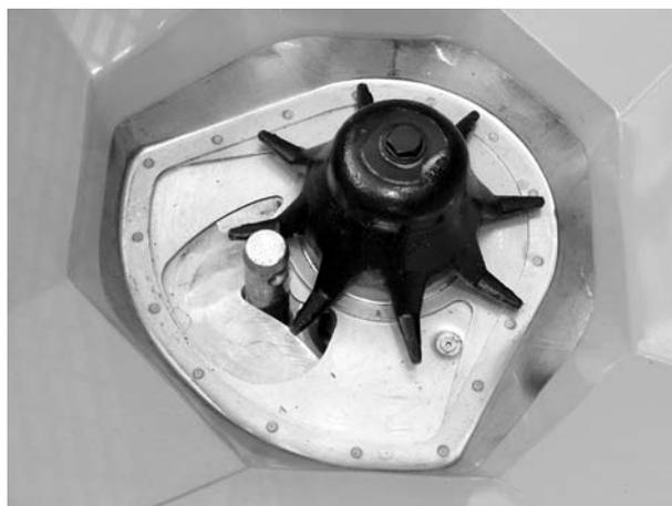
**Figura 20:** Perno del braccio inferiore nell'apertura di dosaggio
