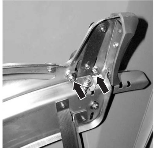
**Figura 25:** Staccare il pannello di taratura del punto di applicazione
