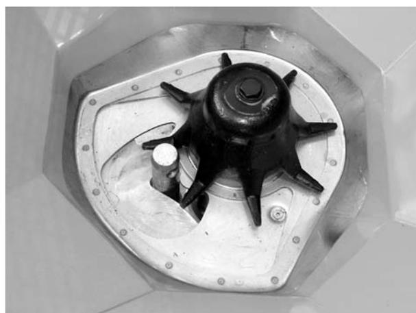
**Figura 25:** Perno del braccio inferiore nell'apertura di dosaggio
