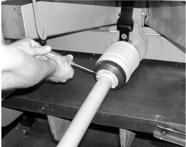
**Figura 8.5:** Assicurare la protezione dell'albero di trasmissione
