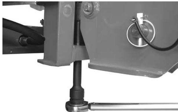
**Figura 18:** Fissaggio della cella di taratura (a sinistra, nel senso di marcia)
