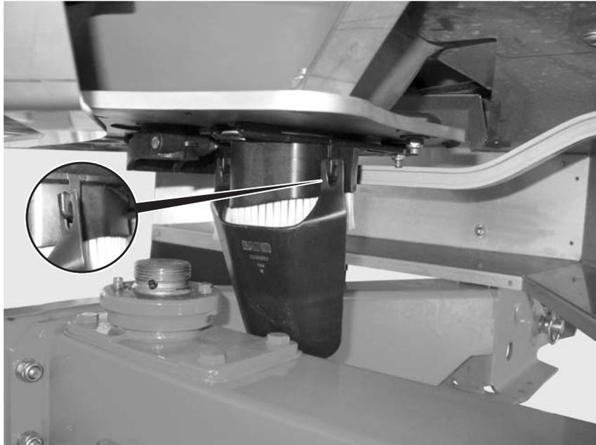
**Imagen 12:** Enganchar el plano inclinado de prueba de giro
