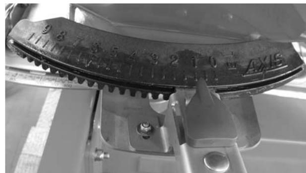
Imagen 42: Comprobar ajuste del punto de aplicación
