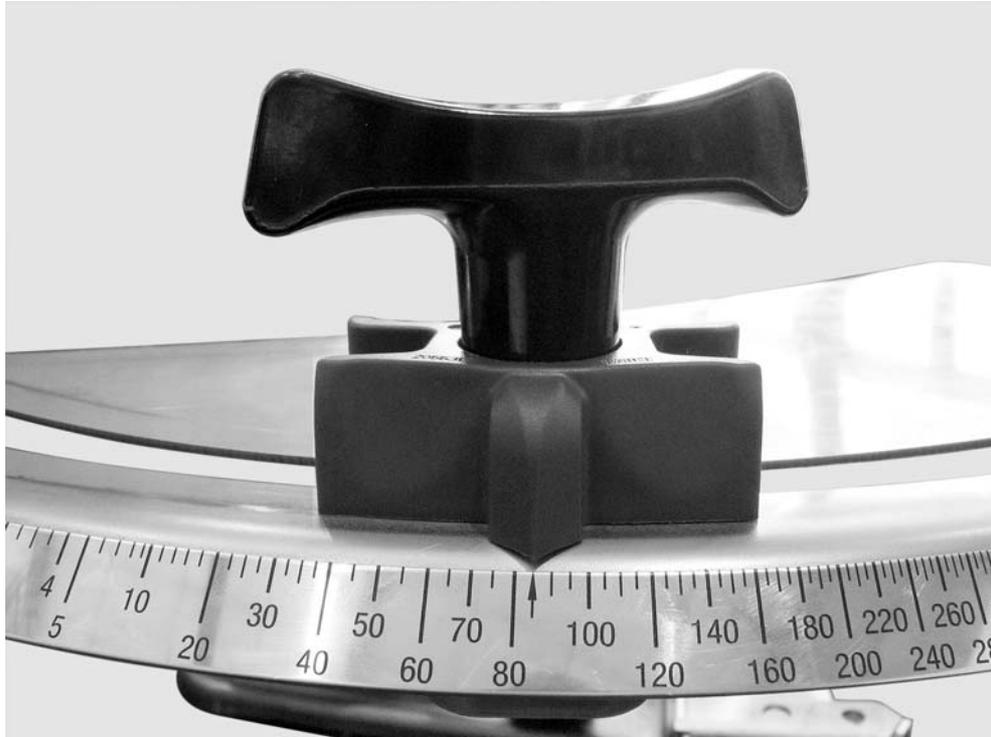
**Imagen 23:** Escala de ajuste de la corredera de dosificación
