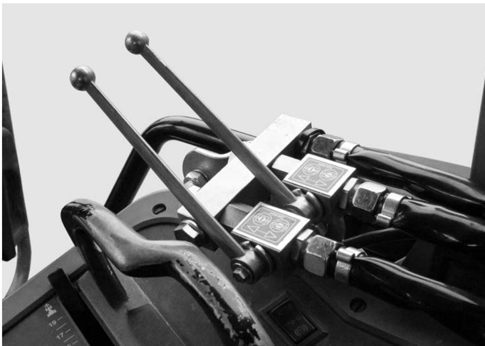
**Imagen 8:** Accionamiento de corredera de la unidad de dos vías
