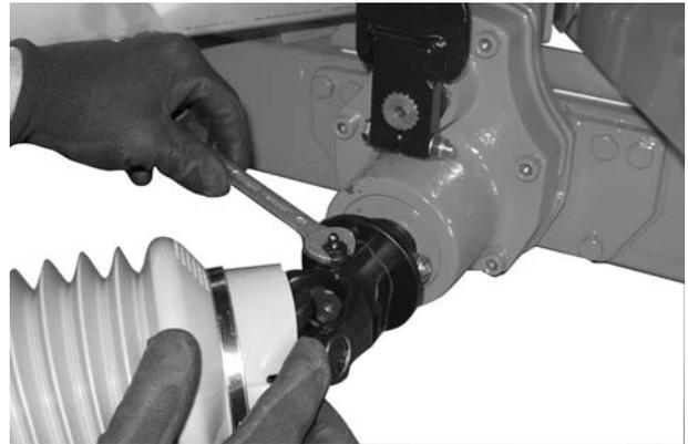
**Imagen 5:** Apretar la boquilla de lubricación
