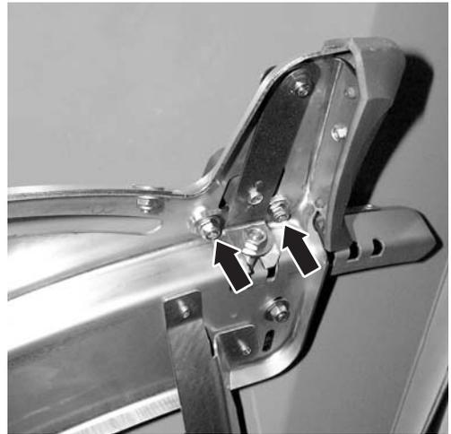
**Imagen 25:** Soltar la chapa de ajuste de punto de extracción
