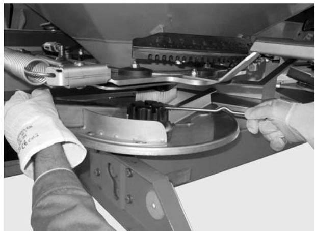
1. Soltar las tuercas de sombrerete de los discos de dispersión por medio de la palanca de ajuste. Retire los discos de dispersión del cubo.
