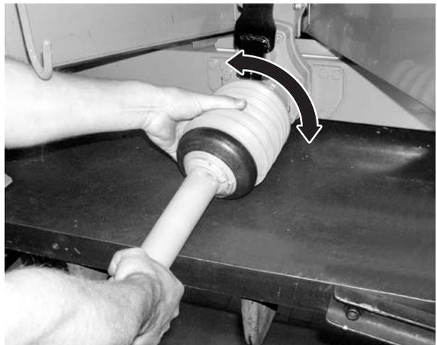
Imagen 8.4: Colocar la protección del eje articulado
