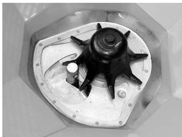
**Imagen 20:** Perno de brazo inferior en el orificio de dosificación
