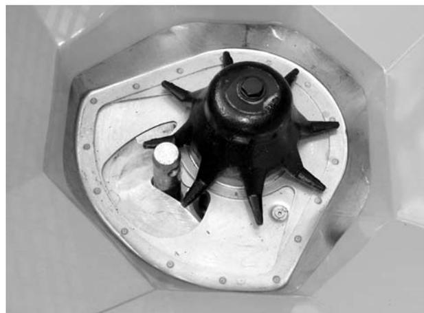
**Imagen 25:** Perno de brazo inferior en el orificio de dosificación
