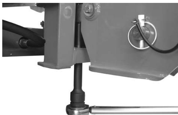
**Imagen 18:** Fijación de la cabina de pesado (en dirección de marcha izquierda)
