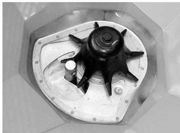
**Imagen 22:** Perno de brazo inferior en el orificio de dosificación
