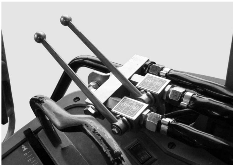
**Imagen 1:** Accionamiento de corredera de la unidad de dos vías
