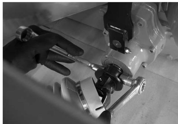
Figure 4 : Fixer l'arbre de transmission
