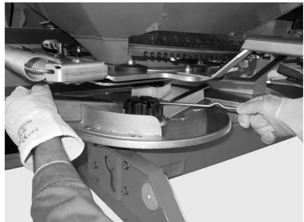
1. Dévisser l'écrou du disque d'épandage avec le levier de réglage. Retirer le disque d'épandage du moyeu.
