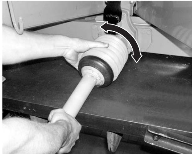
**Figure 8.4 :** Poser la protection de l'arbre de transmission
