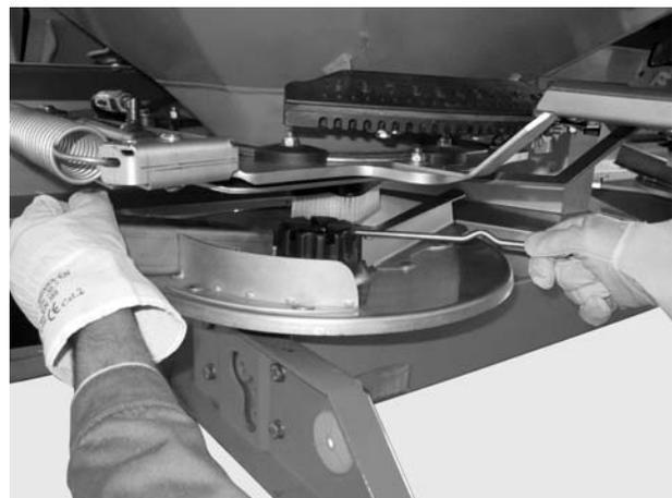
1. Dévisser l'écrou du disque d'épandage avec le levier de réglage. Retirez le disque d'épandage du moyeu.
