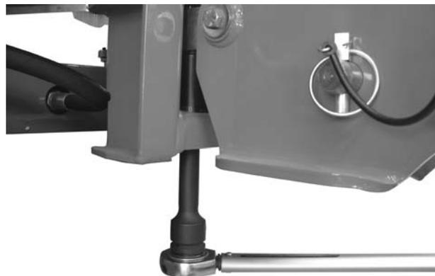
**Figure 18 :** Fixation des pesons (à gauche dans le sens d'avancement)
