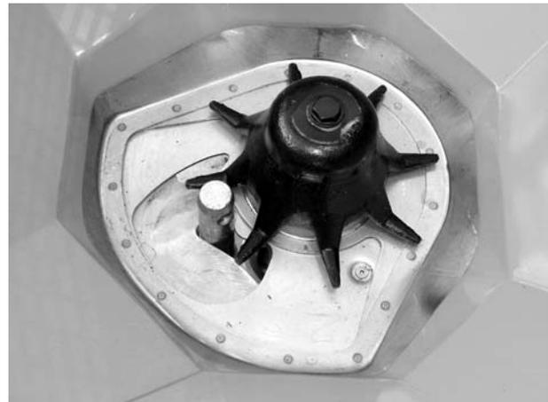
Figure 20 : Axe du bras inférieur dans l'ouverture de dosage
