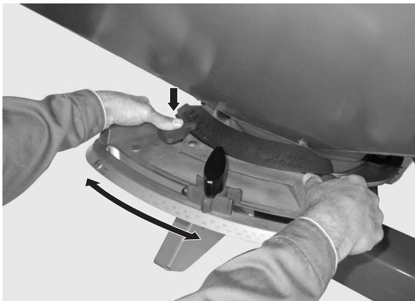
**Figure 14 :** Centre de réglage du point de chute
