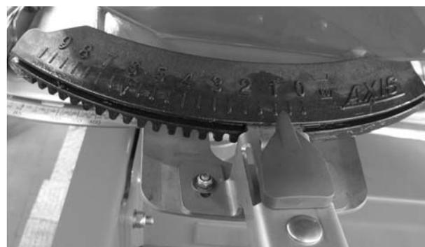
**Figure 42 :** Vérifier le réglage du point de chute
