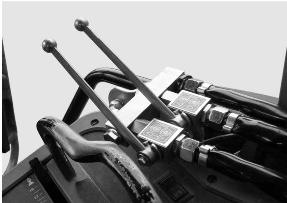
**Figure 8 :** Répartiteur hydraulique
