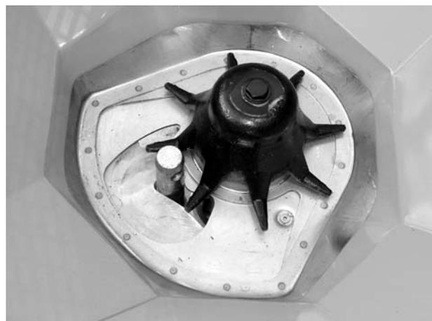
1. Prenez un axe de bras inférieur **d = 28 mm** et placez-le au centre de l'ouverture de dosage.
