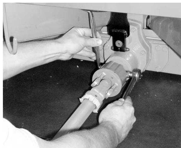
**Figure 8.3 :** Fixer l'arbre de transmission
