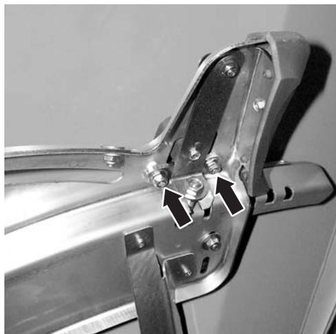
**Figure 25** : Dévisser la tôle de réglage du point de chute
