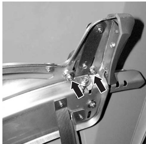
2. Desserrer la tôle de réglage sous le pointeur du point de chute (2 écrous autofreinés).
