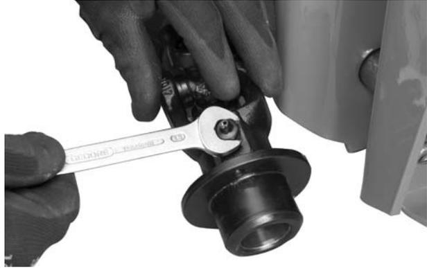
Figure 2 : Dévisser l'embout de graissage
