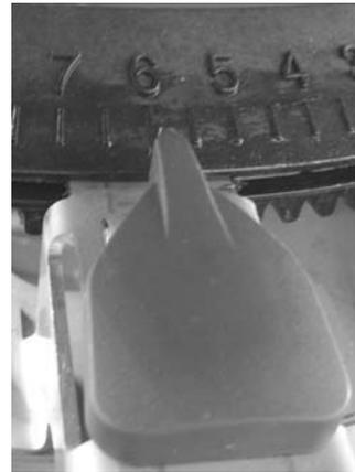
Figure 31 : Régler le point de chute sur la position 6
