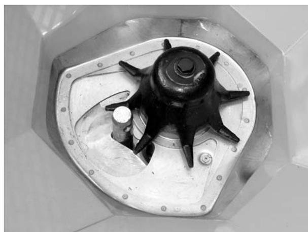
**Figure 25 :** Axe du bras inférieur dans l'ouverture de dosage
