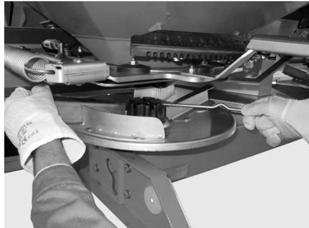
Figure 18 : Desserrer l'écrou
