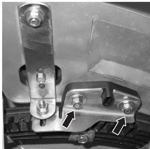
Figure 28 : Dévisser la tôle de réglage du point de chute
