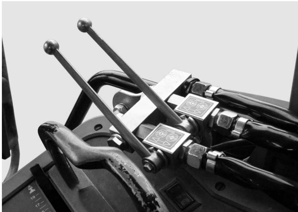
**Figure 1 :** Répartiteur hydraulique
