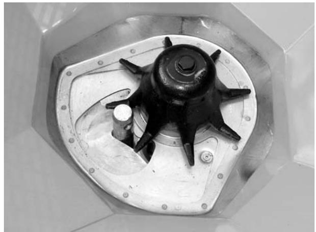
1. Encaixar um pino do braço inferior com um diâmetro de **28 mm** no centro da abertura de dosagem.
