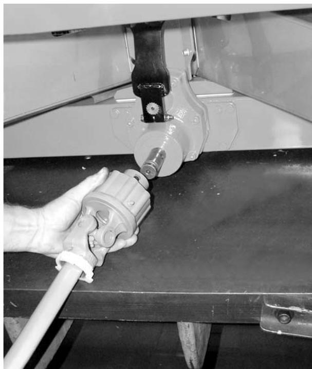
**Figura 7.2:** Inserimento dell'albero cardanico sul perno del cambio.
