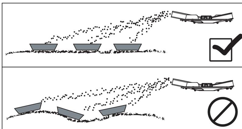
**Figura 7.22:** Disposizione delle vaschette di raccolta
