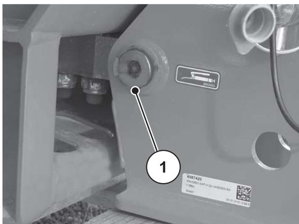
**Figura 10.32:** Punto di lubrificazione dello spanditore a pesata
