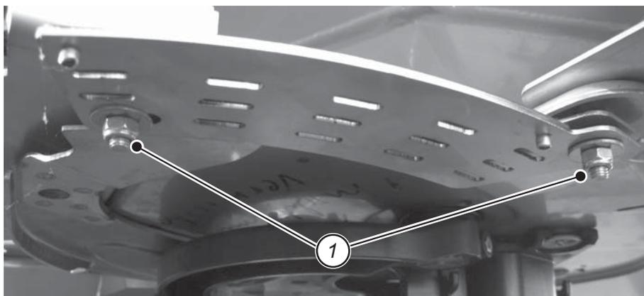
**Figura 10.20:** Viti di fissaggio della scala
