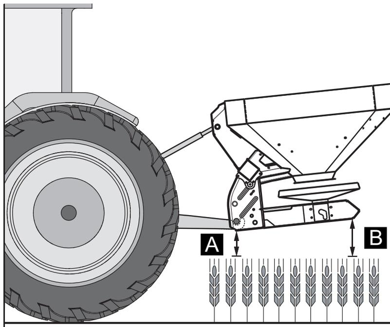
**Figura 7.12:** Macchina montata sui punti di raccordo inferiori del braccio inferiore
