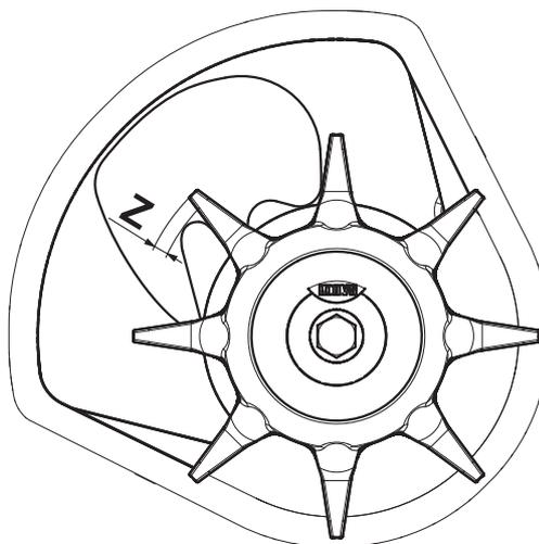
**Figura 10.14:** Limite di usura della testa dell'agitatore
