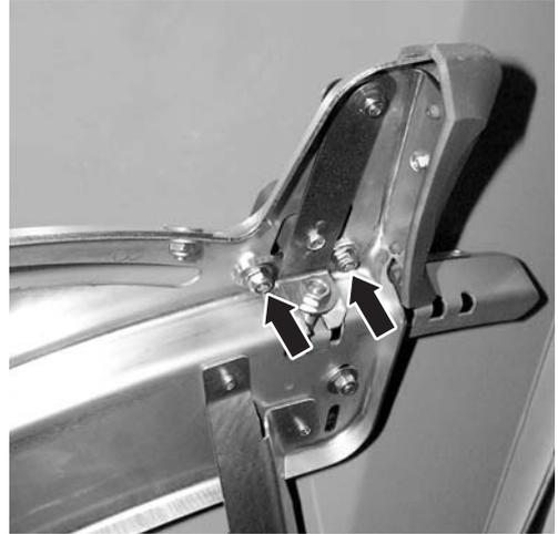
**Figura 10.26:** Staccare il pannello di taratura del punto di applicazione
