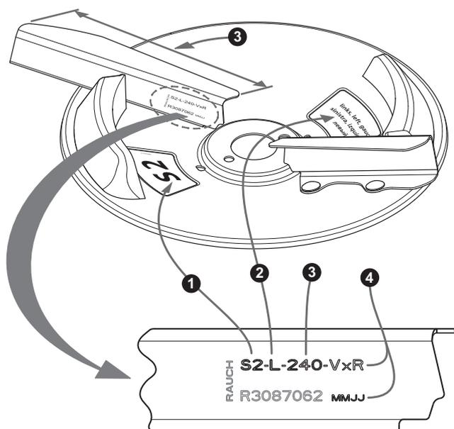
**Figura 10.15:** Indicazione del tipo di disco di lancio
