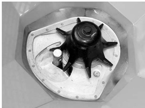
1. Inserire un perno del braccio inferiore con un diametro di **28 mm** al centro dell'apertura del dosatore.
