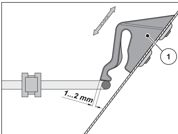
**Figura 10.10:** Misura per il controllo del funzionamento del bloccaggio della griglia protettiva
