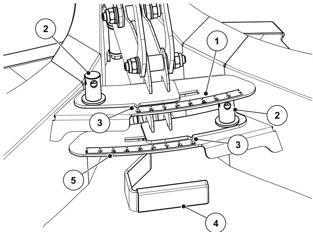
**Figura 7.19:** Regolazione del sistema di distribuzione ai margini
