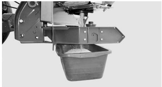
**Figura 8.15:** Esecuzione del test di taratura
