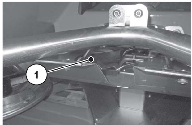
[1] Posizione dello scivolo per il test di taratura
