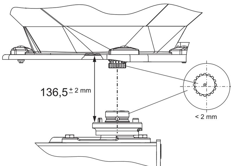
**Figura 10.12:** Controllo della posizione del mozzo del disco di lancio
