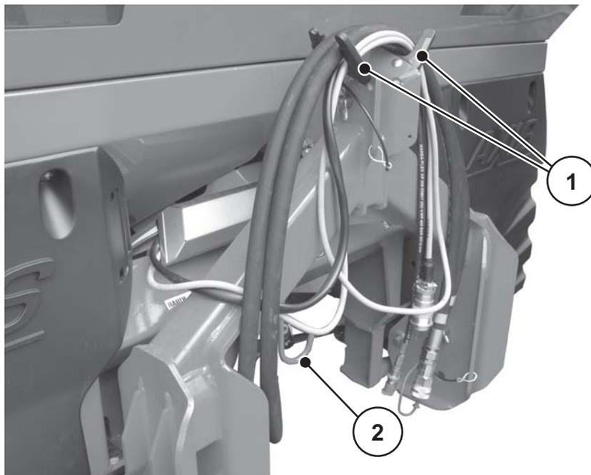
**Figura 8.17:** Posa dei cavi e dei tubi flessibili idraulici
