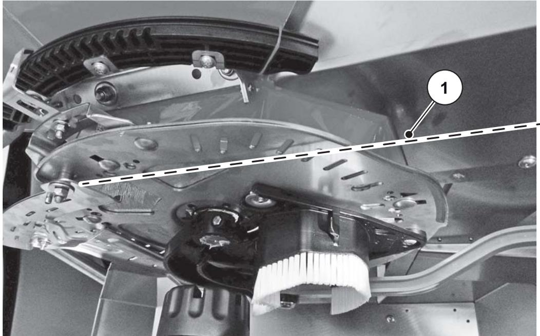
**Figura 10.29:** Posizionamento della corda sul centro di determinazione
