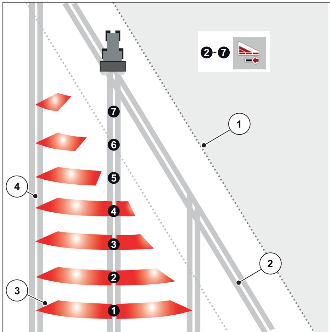
**Figura 8.9:** Esempio di attivazione delle larghezze laterali con VariSpread Pro
