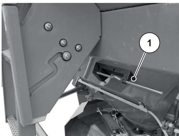
[1] Leva di regolazione (serbatoio, a sinistra nel senso di marcia)
