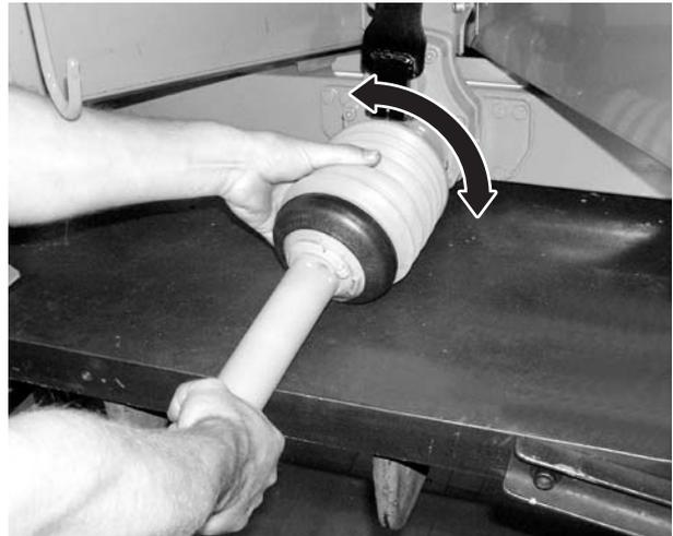
**Figura 7.4:** Posizionare la protezione dell'albero cardanico
