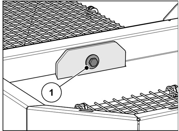
**Figura 10.7:** Fissaggio della barra di trazione nel serbatoio
