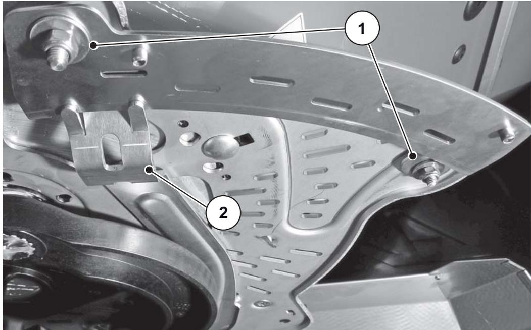
**Figura 10.22:** Viti di fissaggio del settore graduato.
