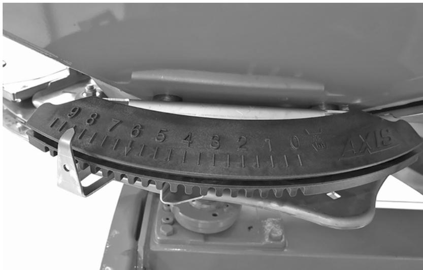
**Figura 8.6:** Indicatore per il punto di applicazione
