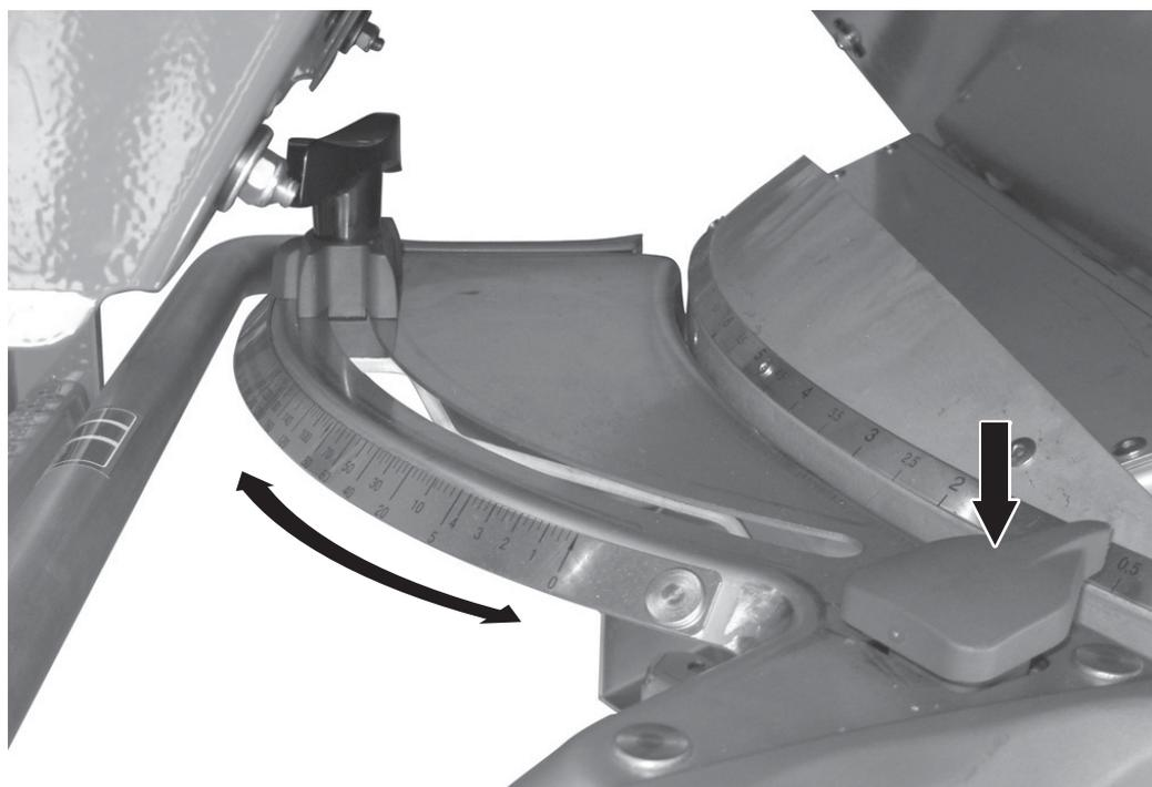
**Figura 8.5:** Regolatore del punto di applicazione
