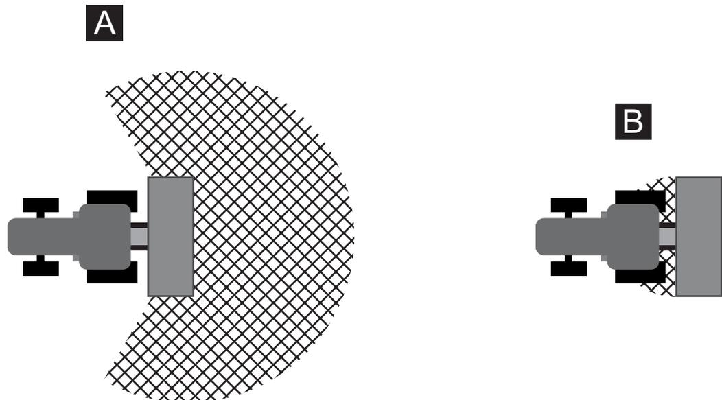
**Figura 3.1:** Zone di pericolo delle testate
