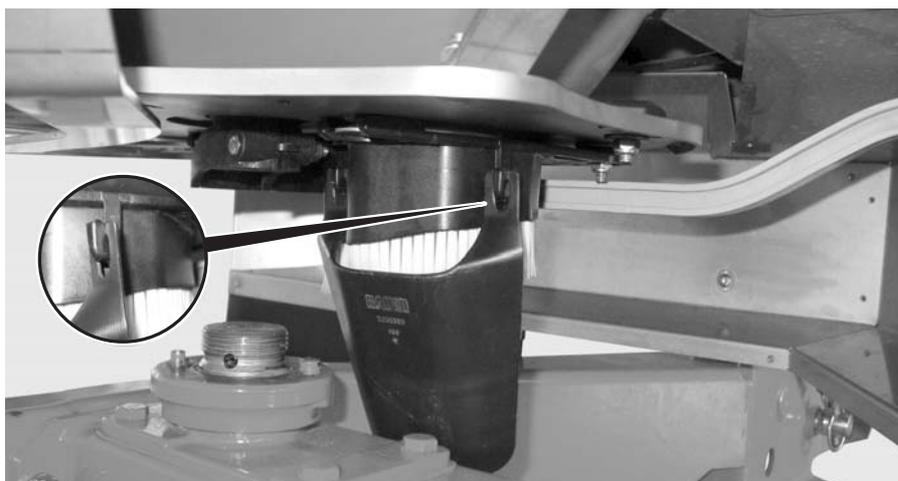
**Figura 8.14:** Agganciare lo scivolo per il test di taratura
