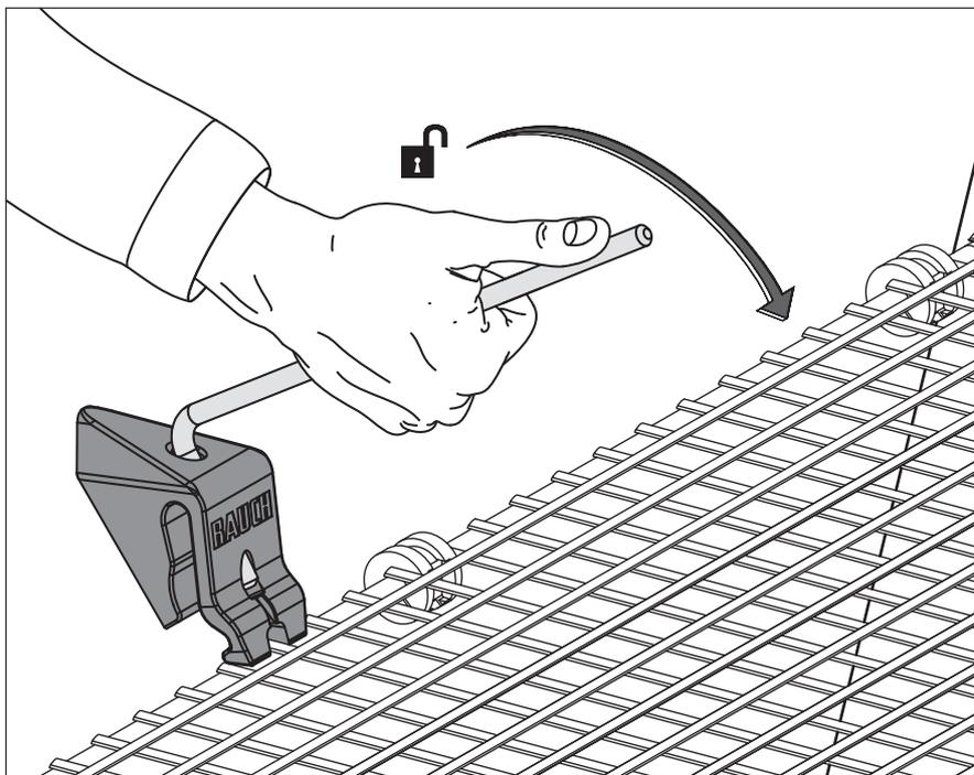
**Figura 10.9:** Apertura del bloccaggio della griglia protettiva
