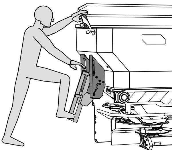
**Figura 10.4:** Utilizzo della scaletta con telo di copertura del serbatoio
