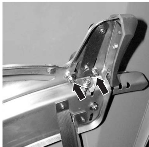
5. 「放出ポイント表示部」下の調整プレートをゆるめます（自動ロックナット2つ）。
