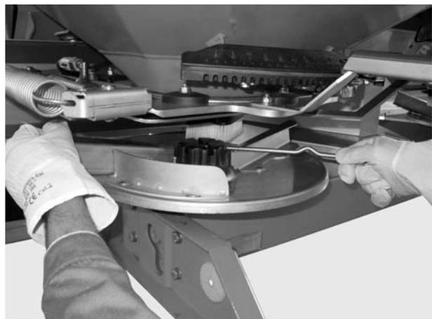
図 8.3: キャップナットをゆるめる
