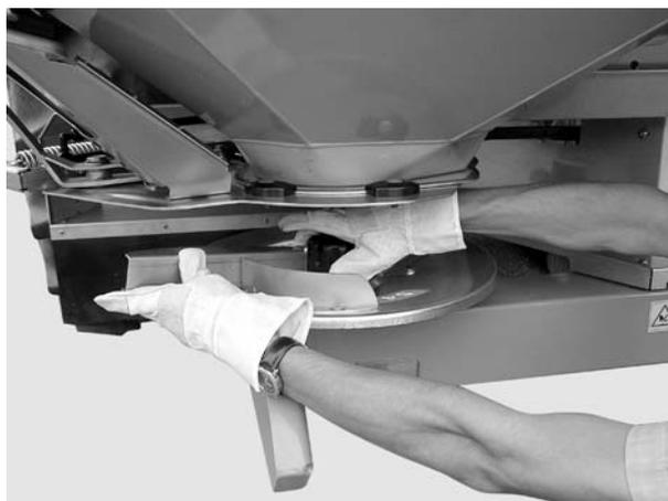
図 8.4: キャップナットを外す
