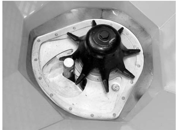
1. ロアリンクピン（直径は 28 mm）をアウトレット中心に差し込みます。
