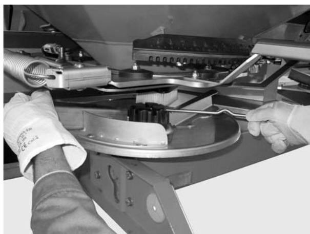
図 8.13: キャップナットをゆるめる
