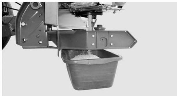
図 8.15: キャリブレーションテストの実施
