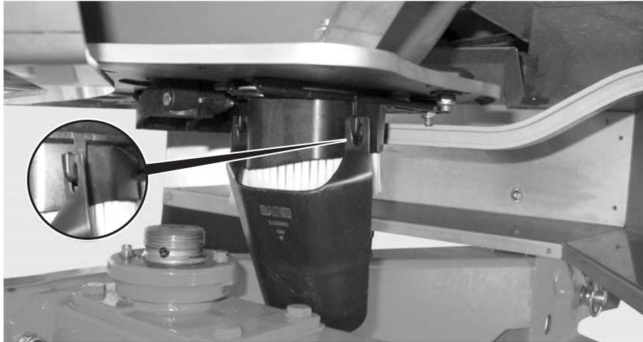
図 8.14: キャリブレーションテストシュートの取付け
