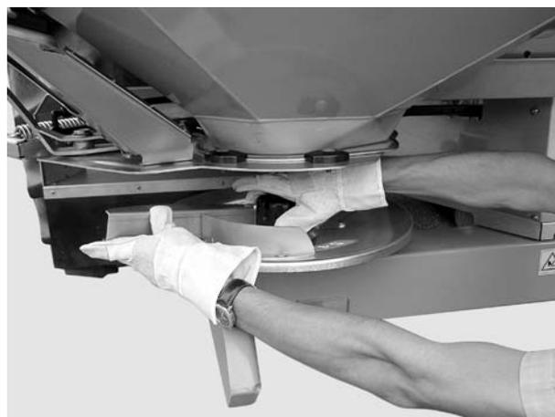
図 8.16: キャップナットを締める
