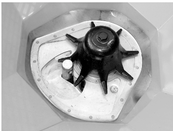
Fig. 58: Trekkstangbolt i doseringsåpning
