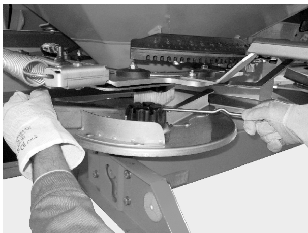
Рис. 36: Отвинчивание колпачковой гайки
