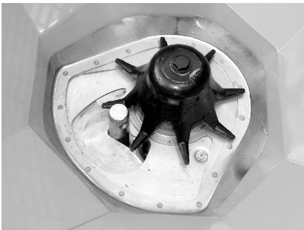
Рис. 58: Болт нижней тяги в дозирующем отверстии
