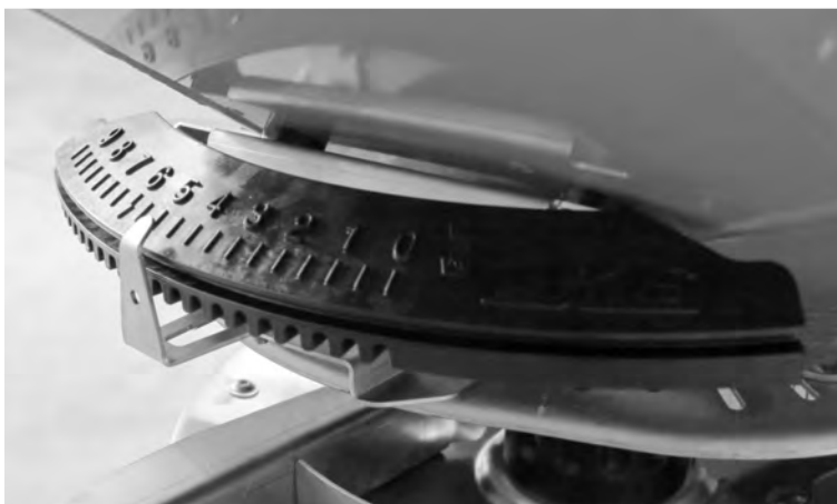
Fig. 30: Afișare pentru punctul de alimentare (exemplu)
