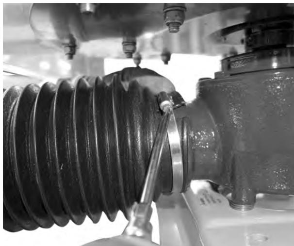
*Ilust. 18: Colocar la protección del eje articulado*
