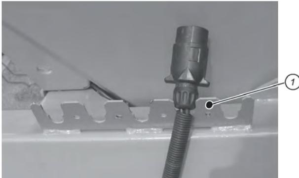
*Ilust. 36: Soporte para cables y latiguillos*
