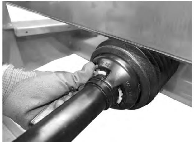
*Abb. 19: Gelenkwellschutz sichern*
