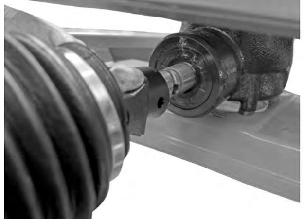
*Abb. 16: Gelenkwelle auf Getriebezapfen aufstecken*
