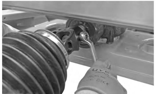
*Abb. 17: Gelenkwelle verbinden*
