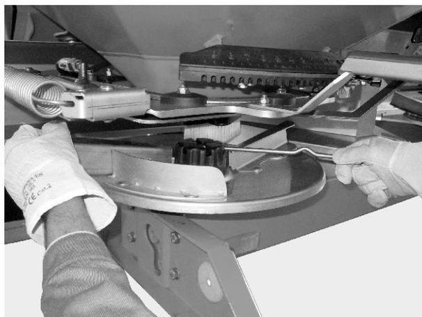
*Fig. 40: Loosen the cap nut*
