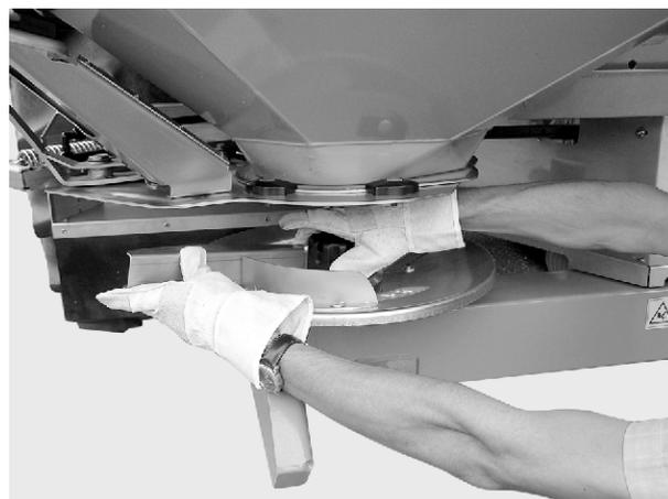
*Fig. 41: Unscrew the cap nut*
