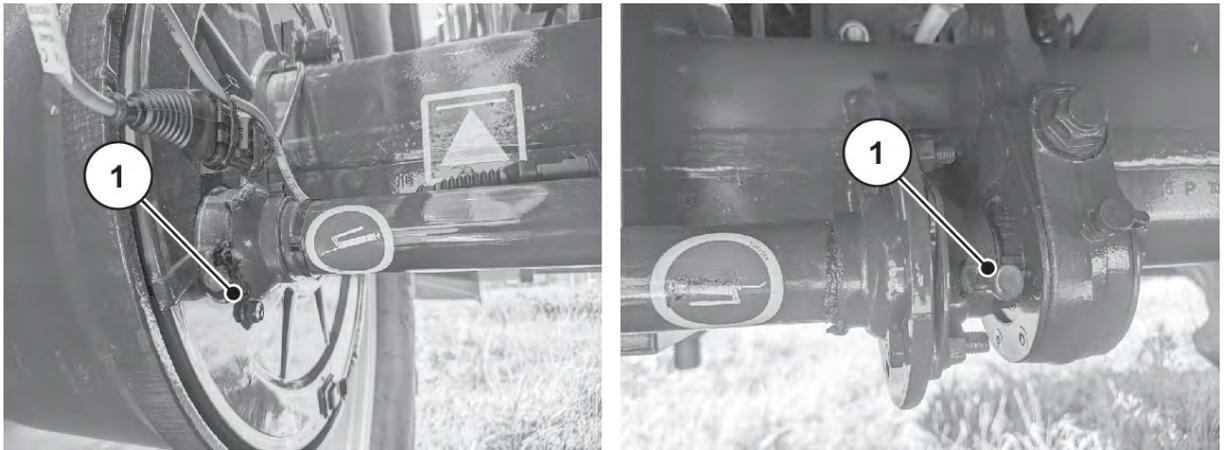
Abb. 64: Bremswellenlagerung Starrachse
