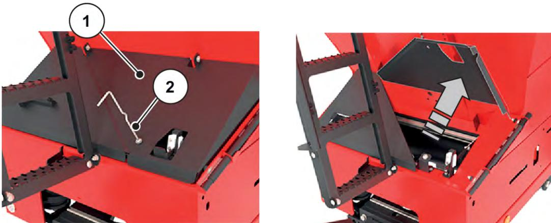
Abb. 67: Vordere Abdeckung öffnen
