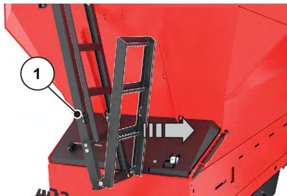
*Abb. 35: Leiterunterteil ausklappen*
