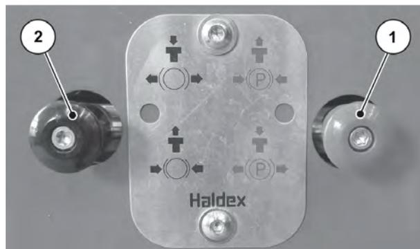
Abb. 32: Feststellbremse lösen
