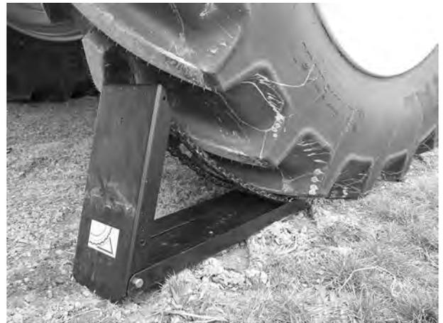
Abb. 51: Unterlegkeil positionieren
