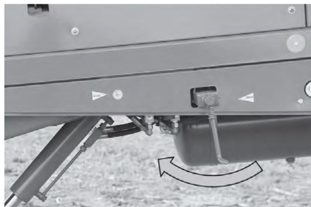
Abb. 49: Feststellbremse (hydraulische Bremsanlage)
