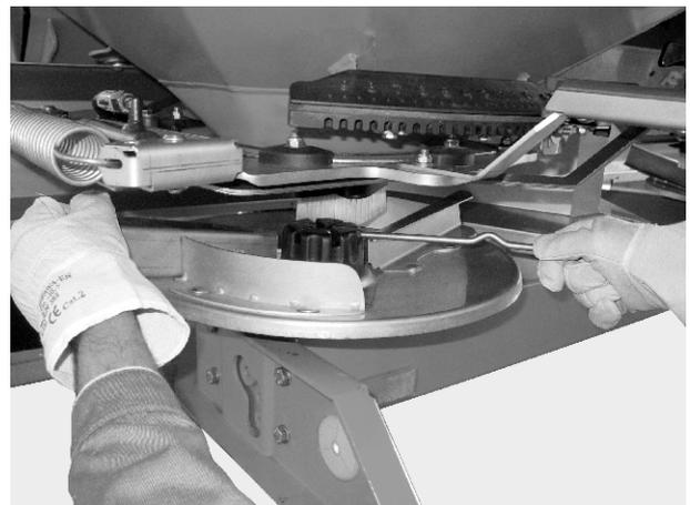
Abb. 42: Hutmutter lösen
