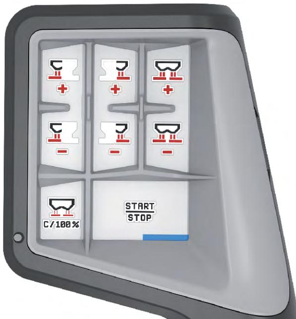
Abb. 35: Tastenbelegung Ebene 3
