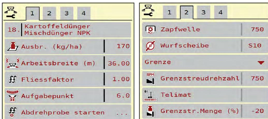
Abb. 10: Menü Dünger Einstellungen, mechanischer Antrieb, Reiter 1 und 2
