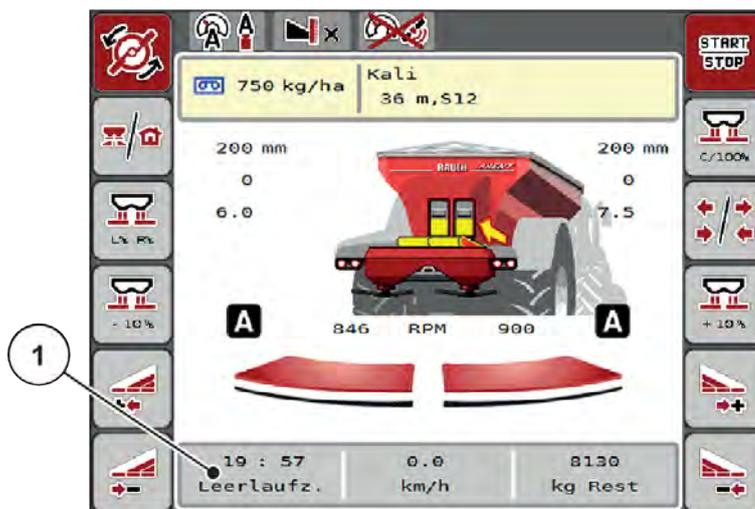
Abb. 43: Anzeige Streubetrieb am Betriebsbild mit GPS Control
