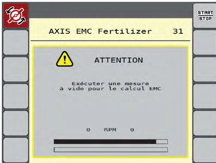
Fig. 47: Affichage Alarme mesure à vide
