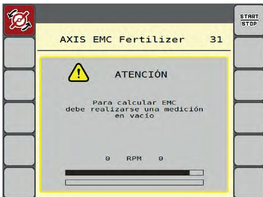
Ilust. 47: Indicador de alarma de medición de marcha en vacío
