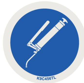
*Ilust. 92: Placa de indicación de los puntos de lubricación*
