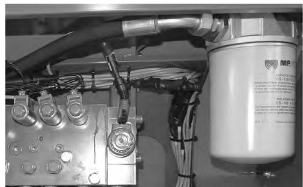
Obr. 112: Olejový filtr u řídicího bloku.
