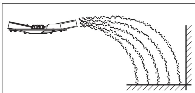
Obr. 65: Hraniční rozmetání při normálním hnojení
