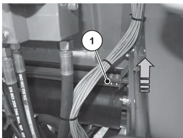
Obr. 53: Čisticí klapka v zavřené poloze, ve směru jízdy dopředu
