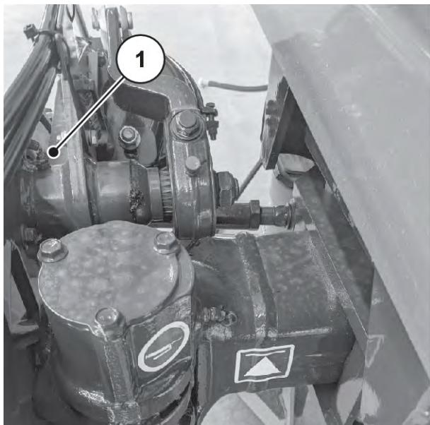
Obr. 100: Uložení hřídele klíče brzdy řiditelné nápravy
