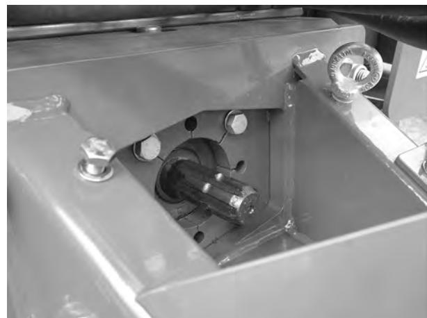
Obr. 22: Namazání čepu převodovky
