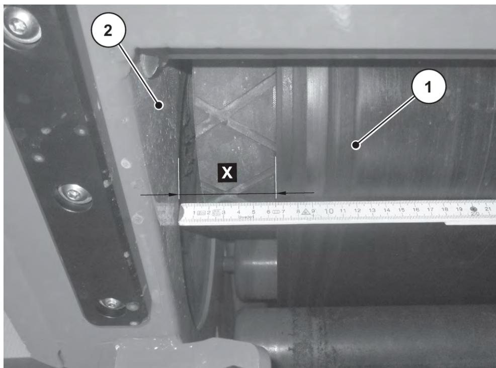
Obr. 123: Kontrola uložení dopravního pásu
