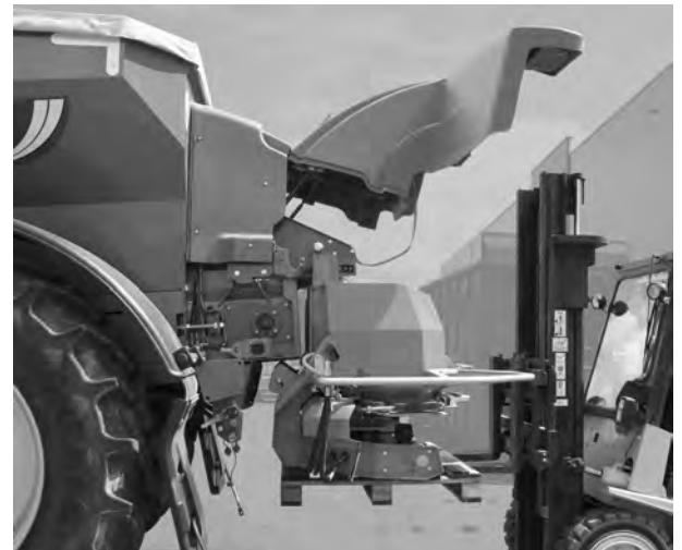
Obr. 46: Najetí vidlicovým vysokozdvížným vozíkem
