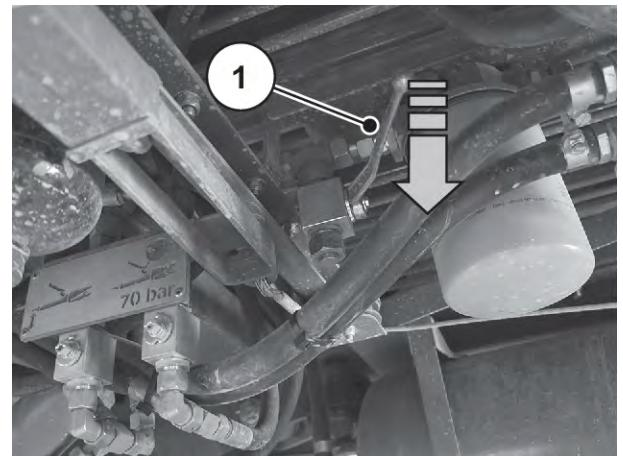
Obr. 111: Vypuštění oleje
