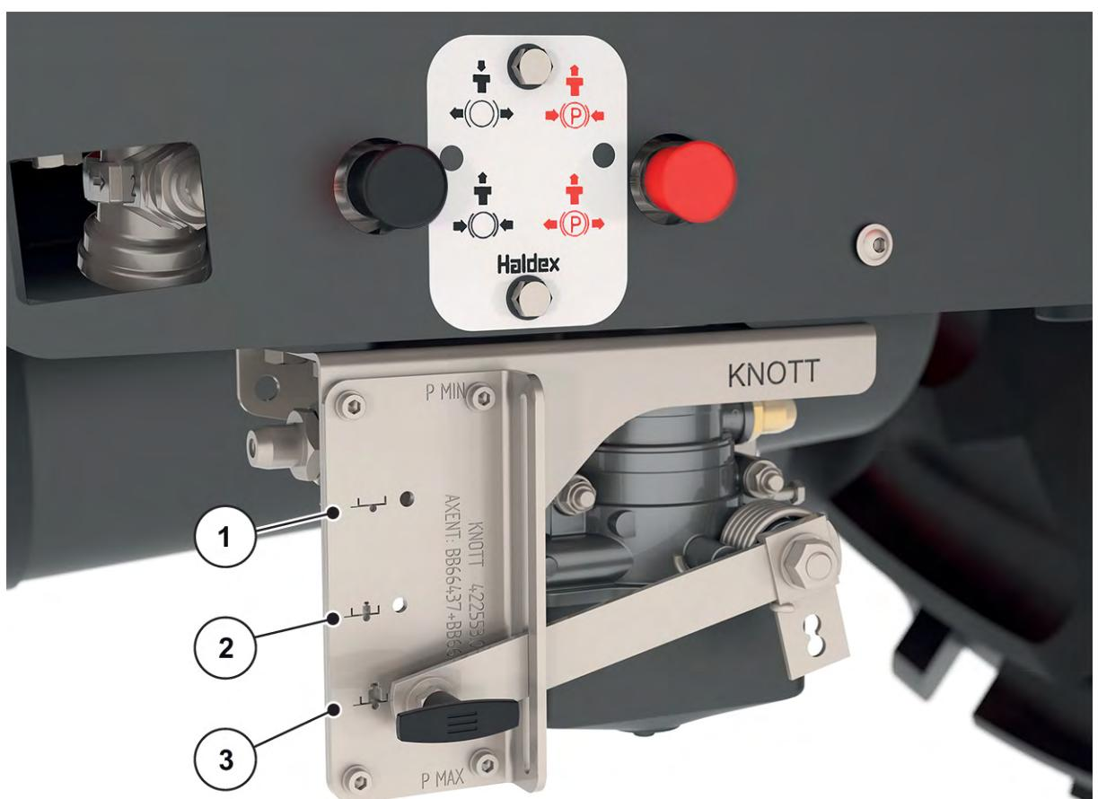
Obr. 31: Nastavení regulátoru brzdné síly
