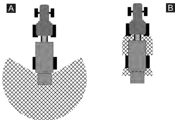
Obr. 1: Nebezpečný prostor u tažených strojů
