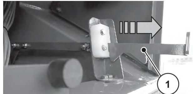
Obr. 91: Páka čisticí klapky
