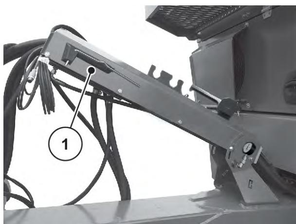
Obr. 116: Poloha nastavovací páky
