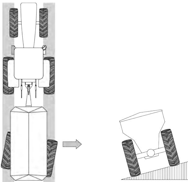
Obr. 74: Řízení ramene nápravy (doplňkové vybavení)
