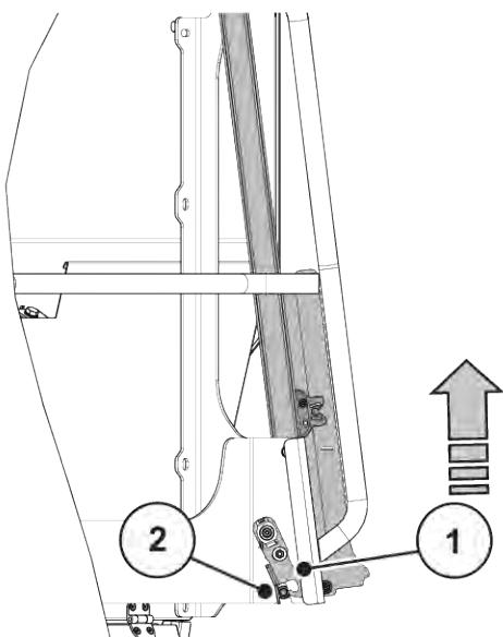
Obr. 55: Horní část nastupovacích schůdků spusťte dolů.
