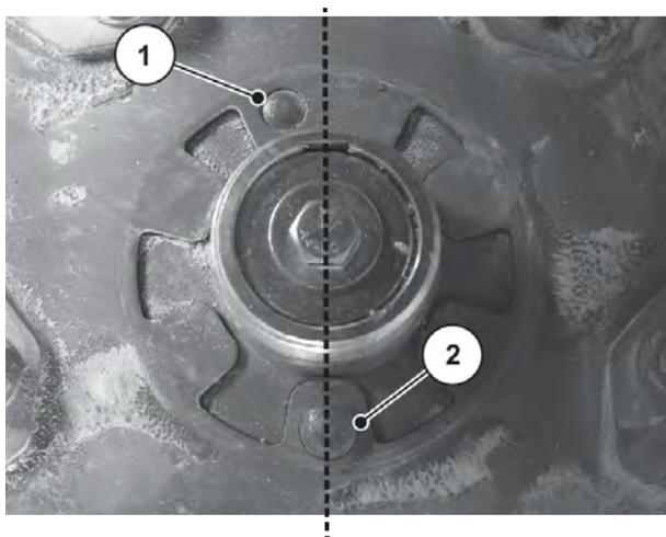
Obr. 117: Rozlišení strany rozmetacího kotouče
