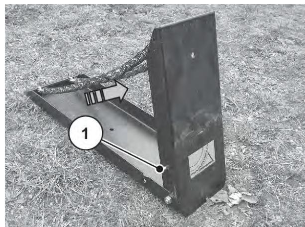
Obr. 85: Odklopení podkládacího klínu
