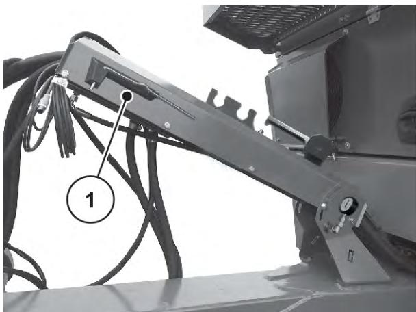
Obr. 67: Poloha nastavovací páky
