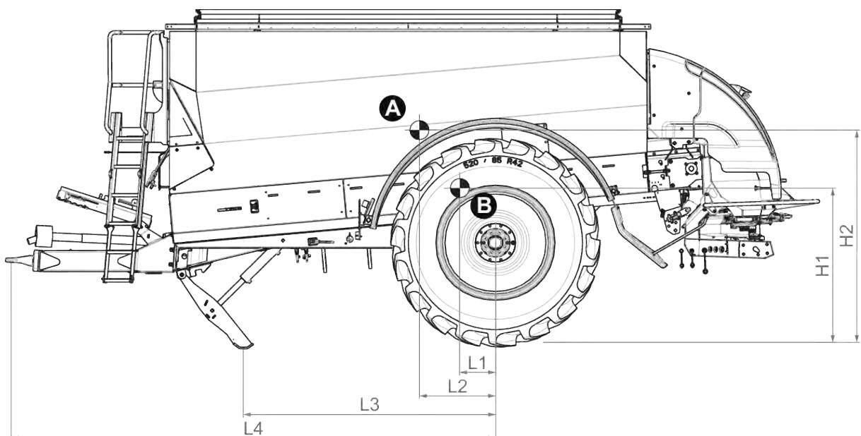
Obr. 16: Poloha těžiště v dolním zavěšení, poloha nápravy vpředu
