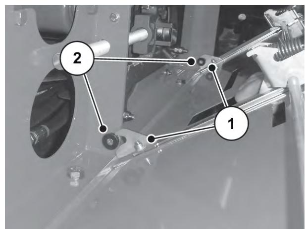
Obr. 90: Montáž bočního krytu
