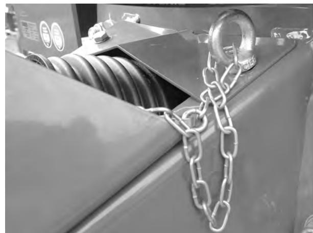
Obr. 25: Upevnění připevňovacího řetízku
