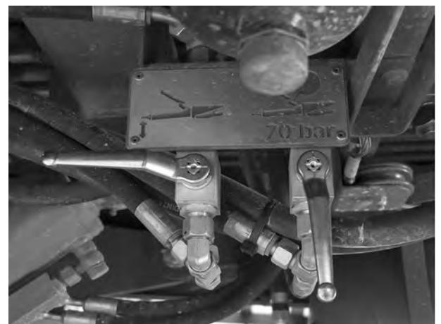
Obr. 120: Zavření levého uzavíracího kohoutu
