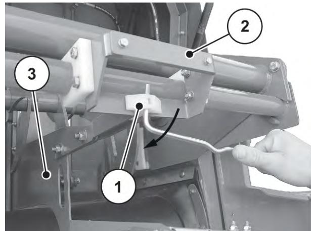
Obr. 37: Demontáž dělicího plechu
