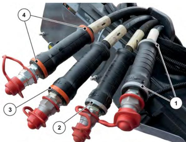
Obr. 27: Označení hydraulických hadic
