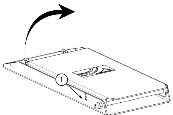
Obr. 81: Odklopení podkládacího klínu
