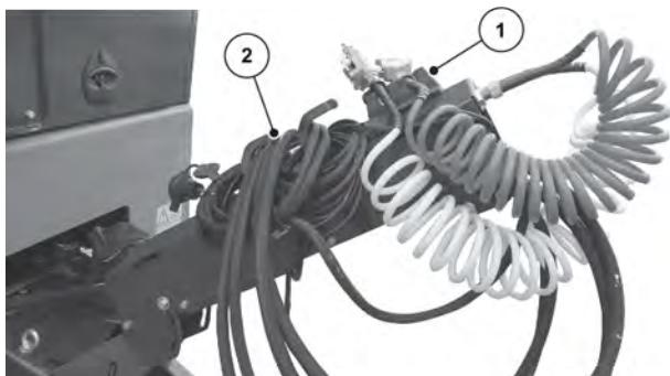
Obr. 83: Odkládací konzola pro kabely, hydraulické hadice a pneumatická vedení
