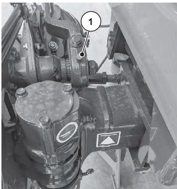
Obr. 102: Automatické seřizování páky brzdových klíčů řiditelné nápravy.
