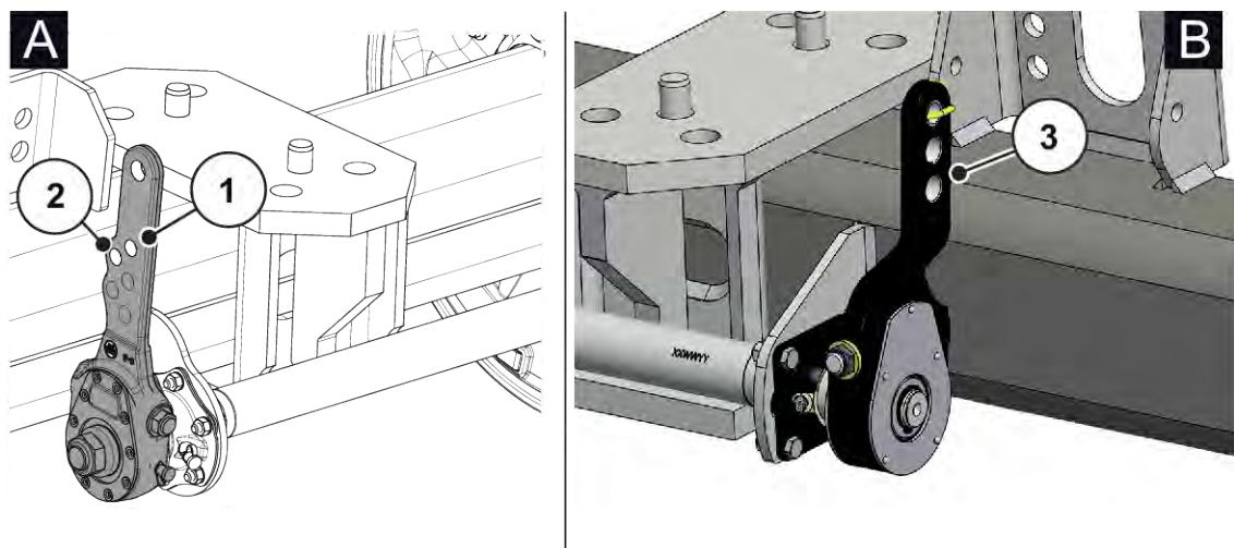
Obr. 136: Poloha spojení brzdová páka/brzdový válec – tuhá náprava
