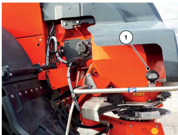
Obr. 20: Doplňkové vybavení SpreadLight
