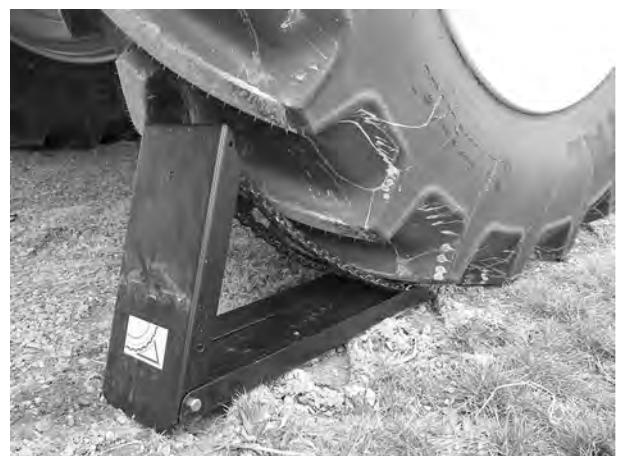
Obr. 82: Umístění klínů pod kola
