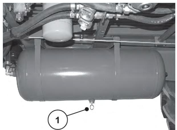
Obr. 134: Vypuštění vody ze vzduchojemu
