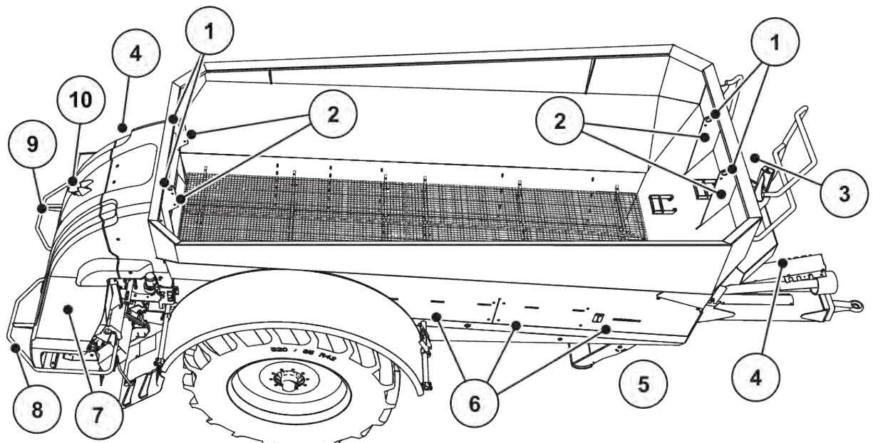
Obr. 4: Ochranná zařízení, nálepky s výstražnými a instruktážními pokyny, zadní strana
