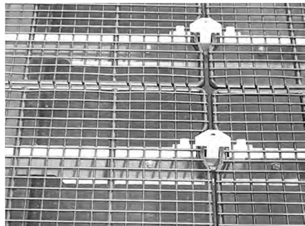
Obr. 44: Plnicí síto v zásobníku
