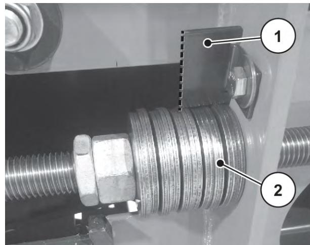
Obr. 125: Napnutí souprav talířových pružin
