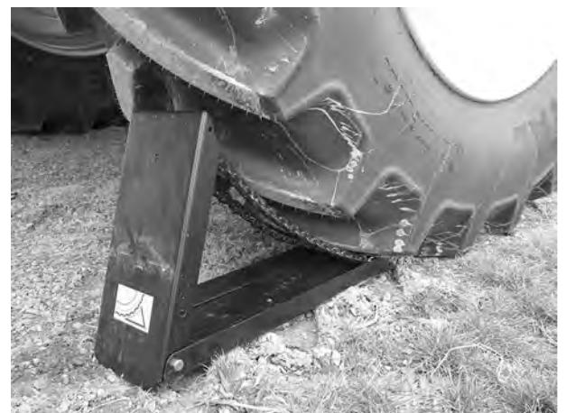
Obr. 86: Umístění klínů pod kola
