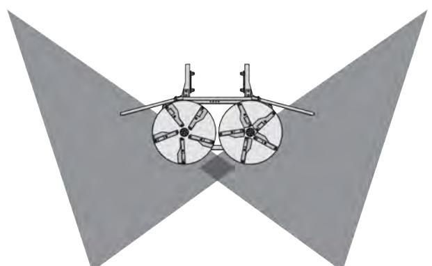
Obr. 78: Příliš málo hnojiva nebo vápna uprostřed
