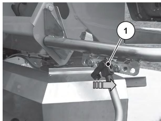
Obr. 49: Upevnění prodloužení blatníku
