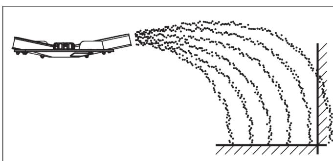
Obr. 66: Okrajové rozmetání při normálním hnojení
