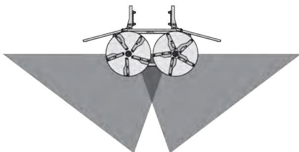
Obr. 75: Normální obraz rozmetání, bod výpadu v neutrální poloze
