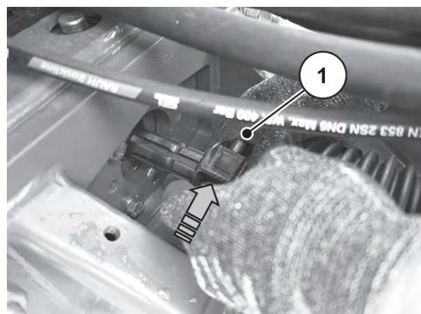
Obr. 23: Nasazení kloubového hřídele na konec vývodového hřídele
