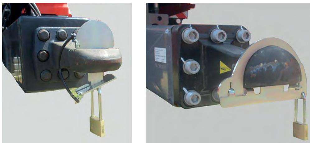
Obr. 12: Pojistka proti neoprávněnému použití tažných zařízení
