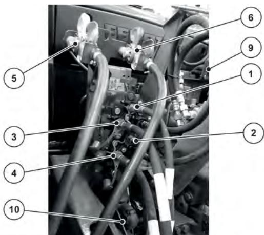
Obr. 26: Pořadí připojení vedení stroje k traktoru
