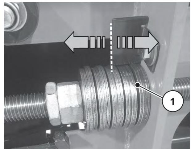
Obr. 127: Úprava souprav talířových pružin
