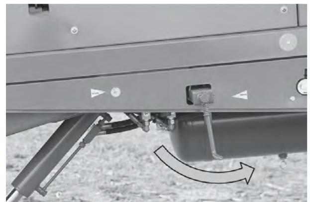
Obr. 34: Ruční odbrzdění parkovací brzdy
