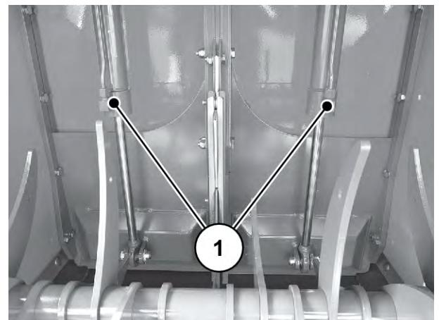
Obr. 108: Hydraulický válec předřazených dávkovacích hradítek
