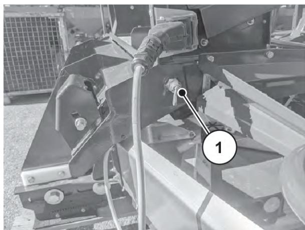
Obr. 104: *Mazací místo univerzálního rozmetacího mechanizmu*
