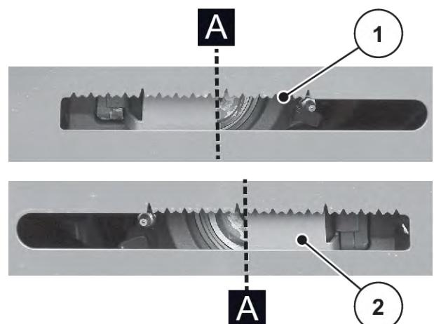
Obr. 126: Nastavení souprav talířových pružin
