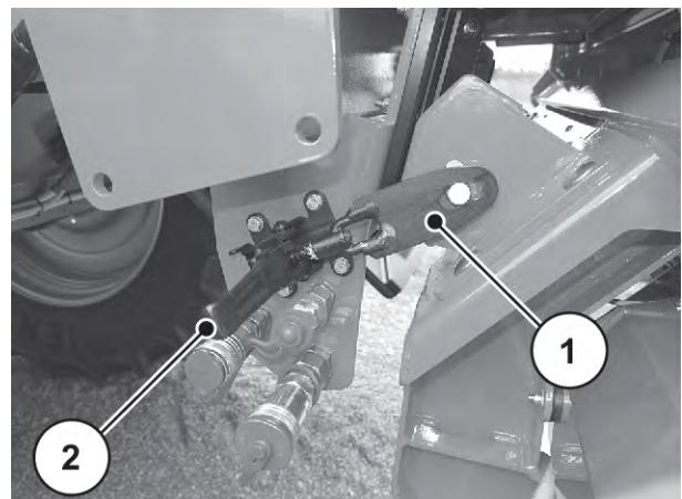
Obr. 50: Odjištění rozmetacího mechanizmu dole
