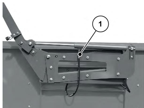
Obr. 109: Hydraulický válec krycí plachty
