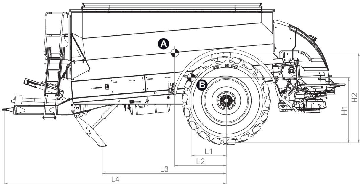
Obr. 17: Poloha těžiště v dolním zavěšení, polohou nápravy vzadu
