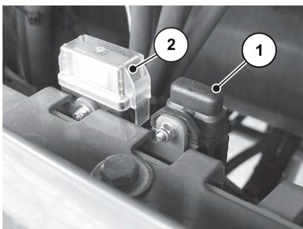
Obr. 106: Pojistky na kabelu ISOBUS
