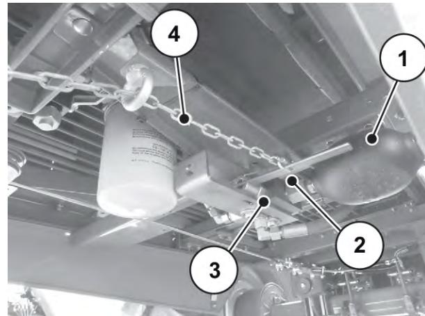
Obr. 32: Pojistka při utržení hydraulické brzdové soustavy
