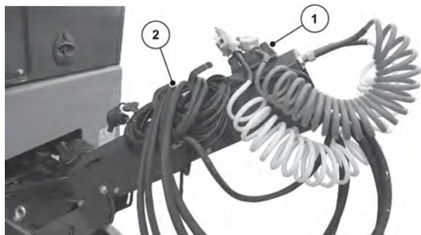
Obr. 87: Odkládací konzola pro kabely, hydraulické hadice a pneumatická vedení
