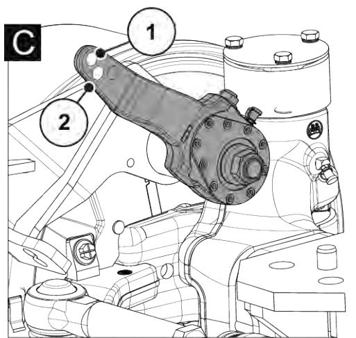
Obr. 137: Poloha spojení brzdová páka/brzdový válec – řiditelná náprava
