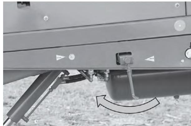
Obr. 84: Ruční zatažení parkovací brzdy
