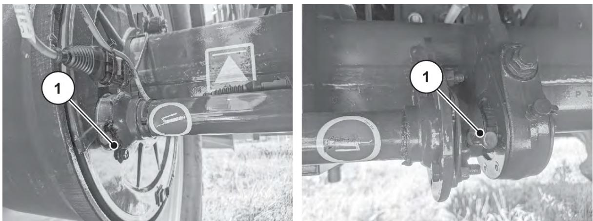
Obr. 99: Uložení hřídele klíče brzdy tuhé nápravy
