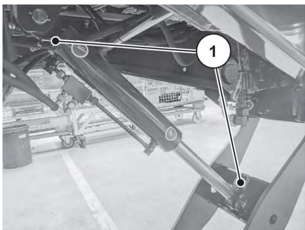
Obr. 95: Hydraulický válec opěrné patky
