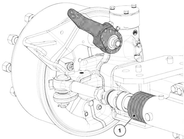
Obr. 114: Vymezovací podložky řiditelné nápravy
