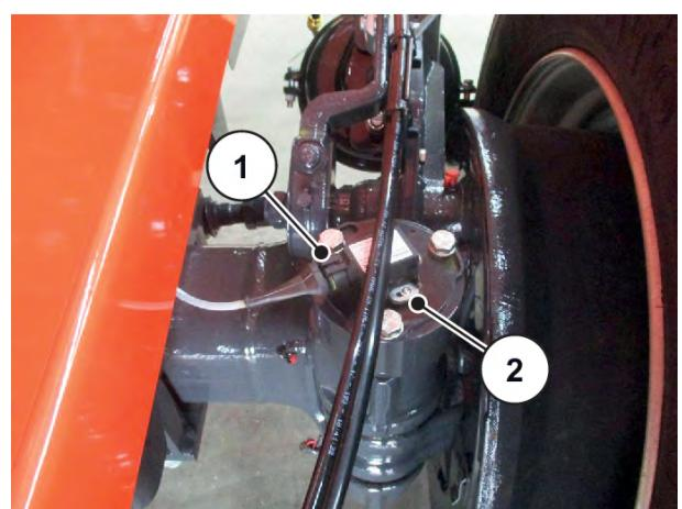
Obr. 115: Snímač úhlu nápravy
