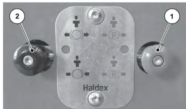
Obr. 80: Ruční zatažení parkovací brzdy
