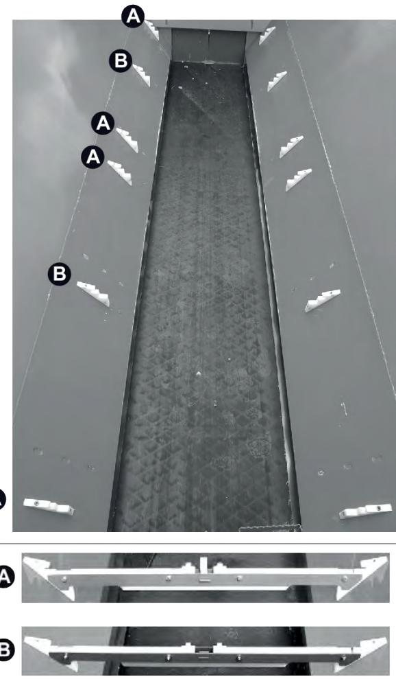
Obr. 41: Instalace držáků na plnicí síto
