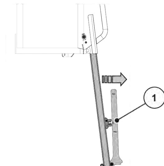
Obr. 56: Odklopení dolní části nastupovacích schůdků
