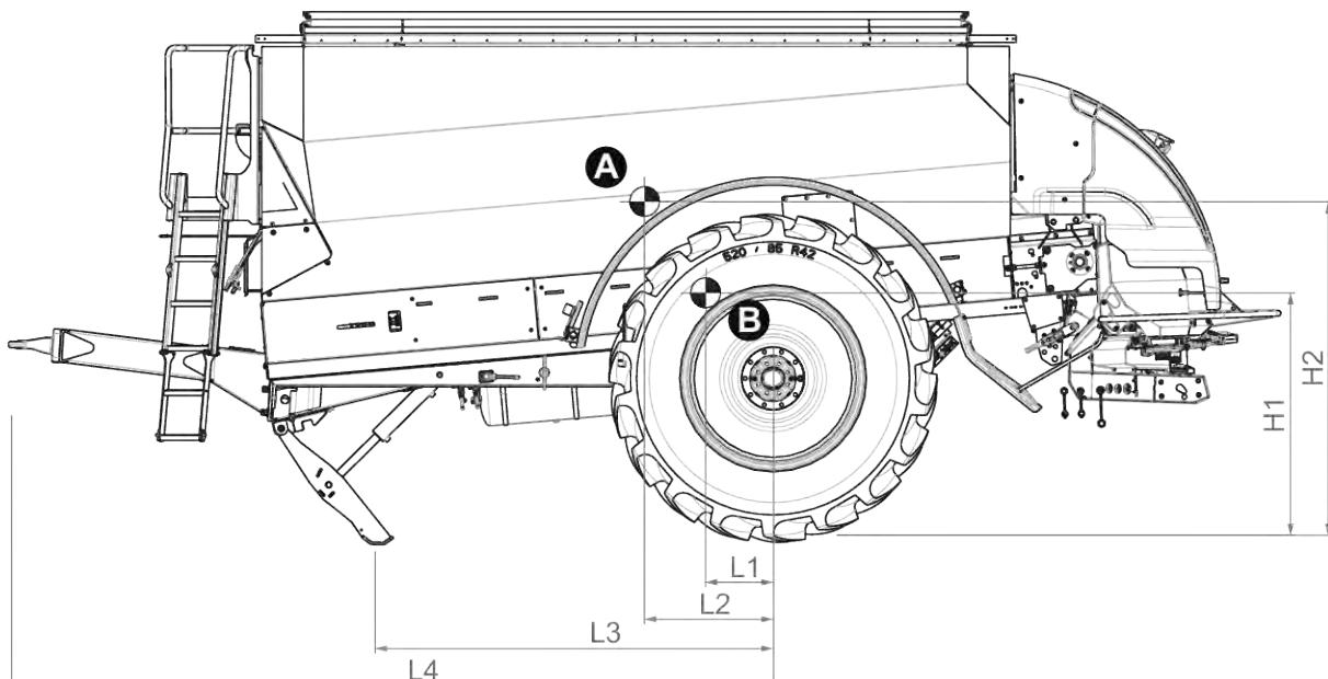
Obr. 15: Umístění těžiště v horním zavěšení
