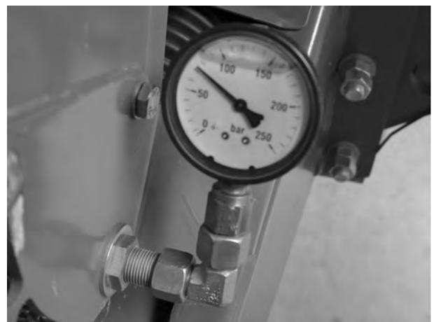
Obr. 122: Manometr na kabelovém vedení nad ojí
