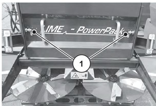
Obr. 105: *Mazací místo univerzálního rozmetacího mechanizmu*
