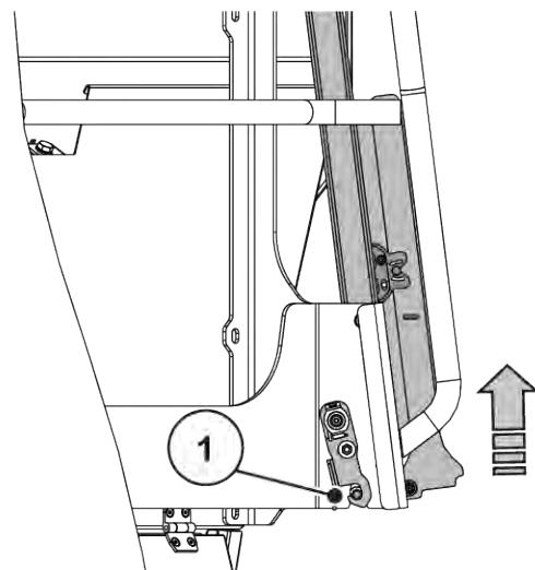
Obr. 58: Zajištění posuvné části
