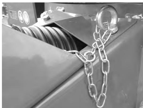
III. 25: Fissaggio della catena di sostegno
