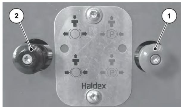
III. 33: Disinserimento del freno di stazionamento
