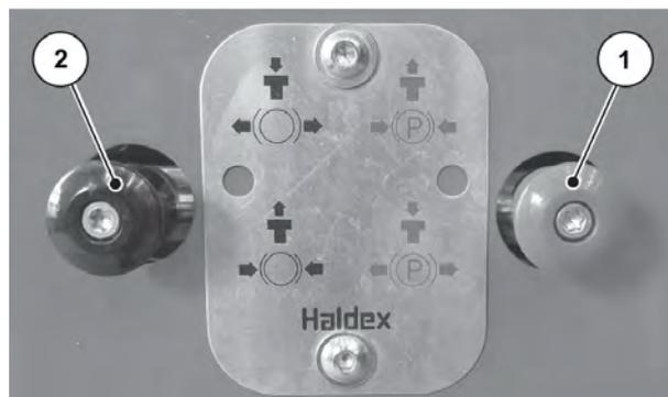
*III. 80: Azionamento manuale del freno di stazionamento*
