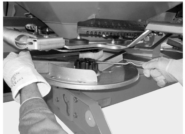
Fig. 68: Loosen the cap nut
