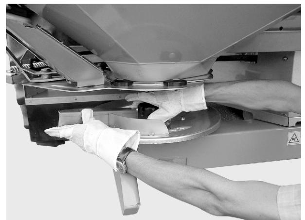
Fig. 69: Unscrew the cap nut
