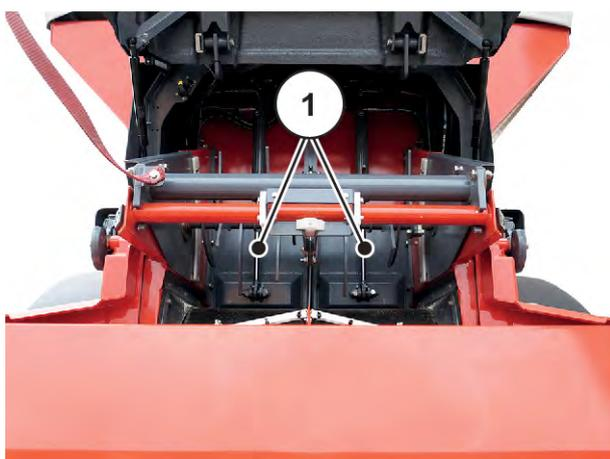
Fig. 52: Vannes de pré-dosage en position fermée.
