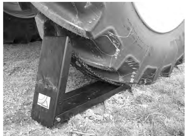
*Fig. 82: Positionner une cale*
