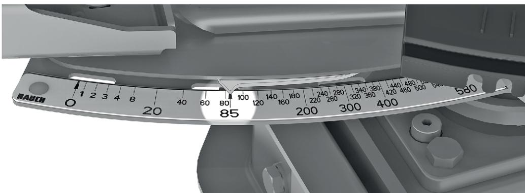
Fig. 71: Échelle graduée indiquant la dose d'épandage
