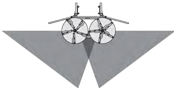
Fig. 75: Schéma d'épandage normal, point de chute en position neutre
