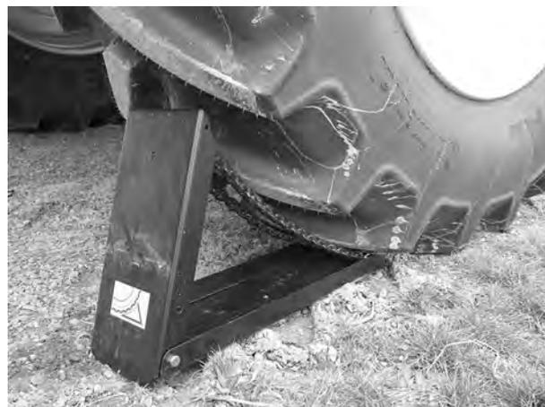
Fig. 86: Positionner une cale
