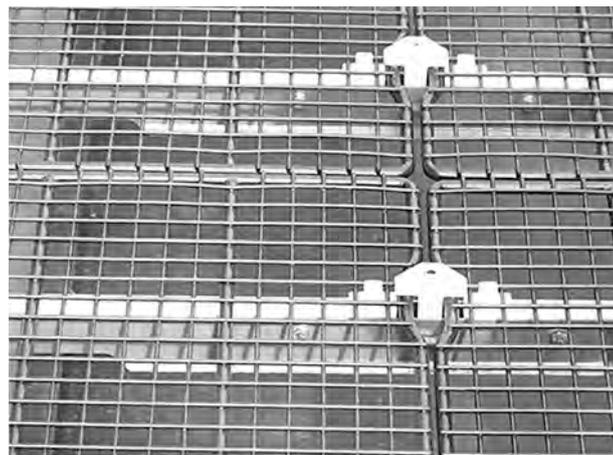
Fig. 44: tamis de remplissage dans la trémie
