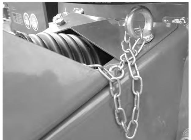
Fig. 25: Fixer la chaîne de maintien
