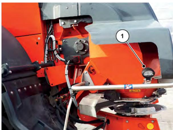
Fig. 20: Équipement spécial SpreadLight
