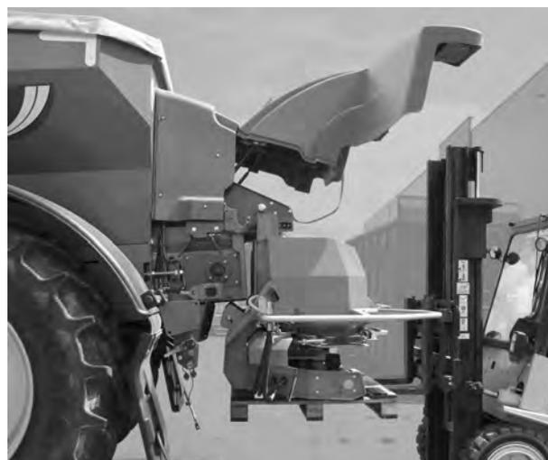
Fig. 46: Approcher le chariot élévateur à fourche.
