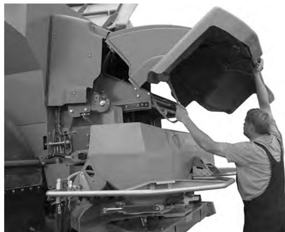
Fig. 62: Tirer la bande de traction
