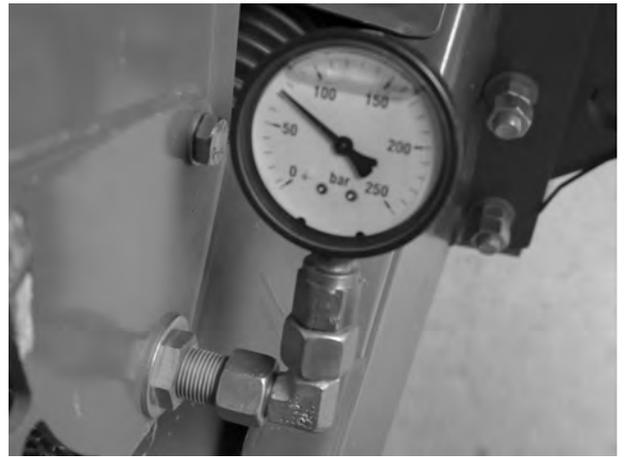
Fig. 122: Manomètre sur le guide-câbles sur timon
