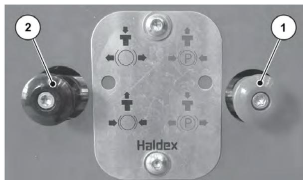
Fig. 77: Serrage du frein de stationnement manuel
