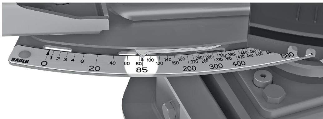
Fig. 68: Échelle graduée indiquant la dose d'épandage
