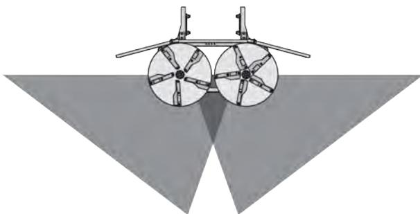
Fig. 72: Schéma d'épandage normal, point de chute en position neutre
