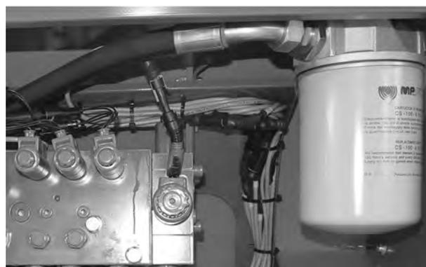
Fig. 105: Filtre à huile Bloc de commande
