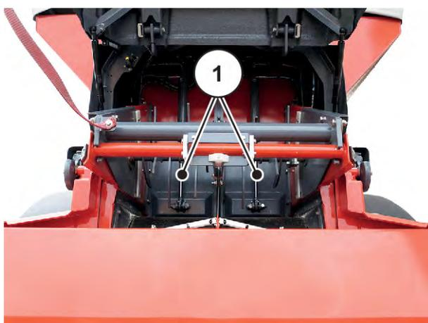
Fig. 49: Vannes de pré-dosage en position fermée.
