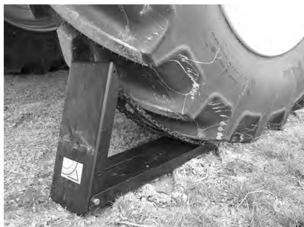
Fig. 79: Positionner une cale
