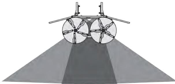
Fig. 76: Trop d'engrais ou de chaux au milieu
