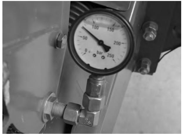
Fig. 115: Manomètre sur le guide-câbles sur timon
