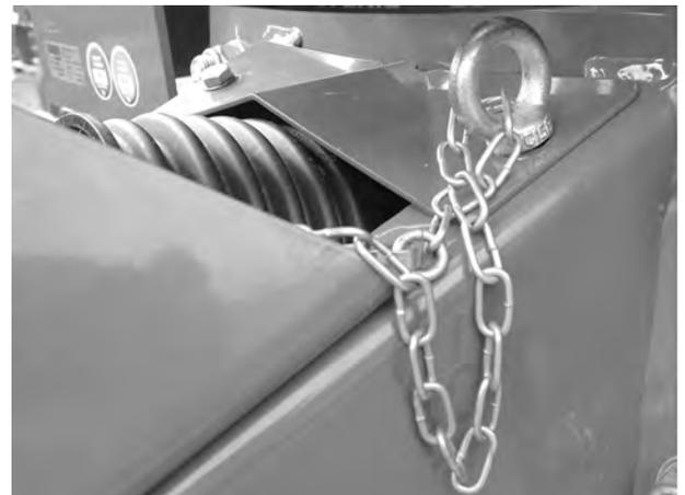
Fig. 24: Fixer la chaîne de maintien
