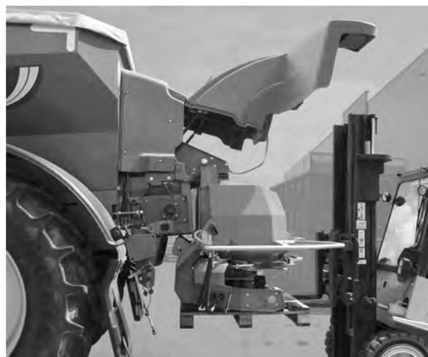
Fig. 43: Approcher le chariot élévateur à fourche.
