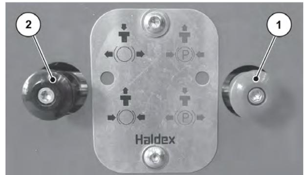
Abb. 77: Manuelle Feststellbremse ziehen
