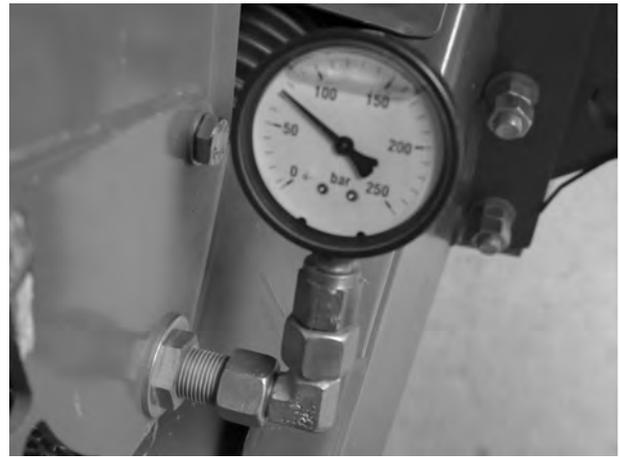
*Abb. 115: Manometer an Kabelführung über Deichsel*
