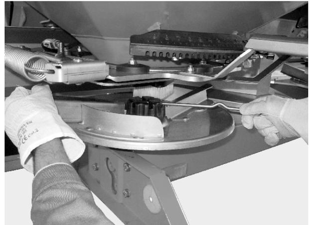
Abb. 65: Hutmutter lösen
