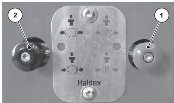
Abb. 31: Feststellbremse lösen
