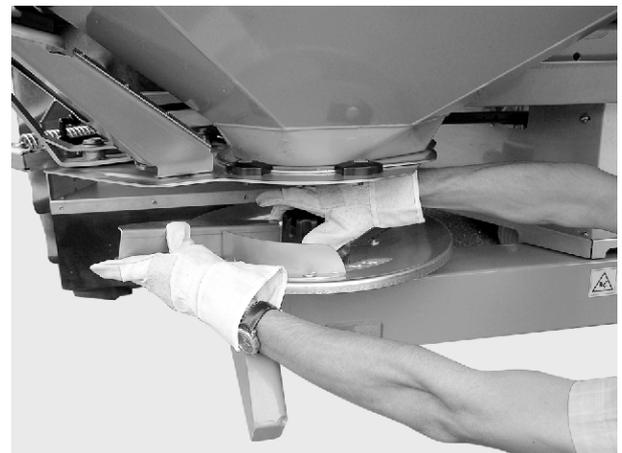
Abb. 66: Hutmutter abschrauben
