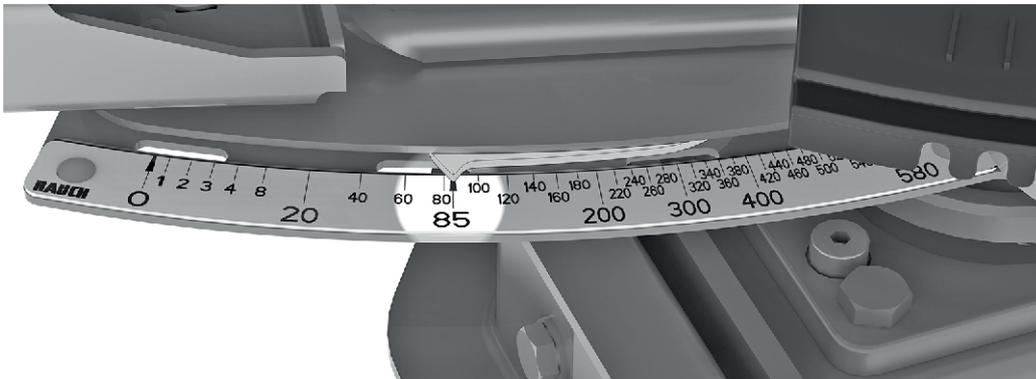
Abb. 68: Skala zur Anzeige der Ausbringungsmenge
