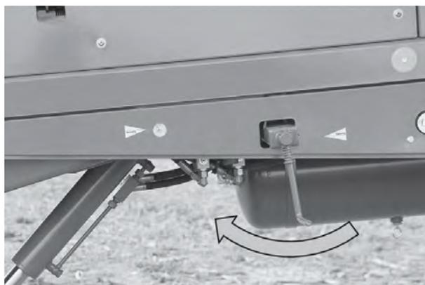
*Ilust. 84: Aplicar el freno de estacionamiento manual*
