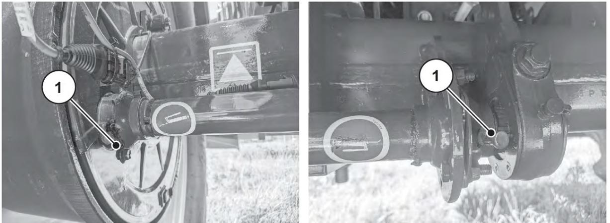
*Ilust. 99: Cojinete del eje de freno del eje rígido*
