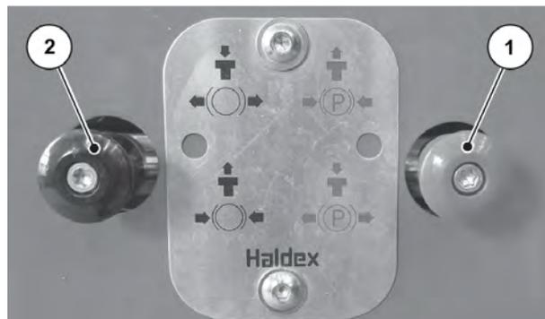
*Ilust. 80: Accionar el freno de estacionamiento manualmente*
