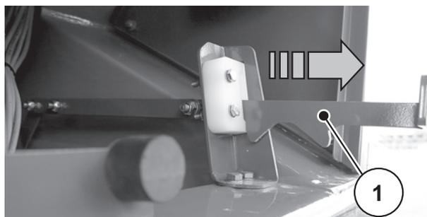
Рисунок 9.5: Рычаг очищающей заслонки
