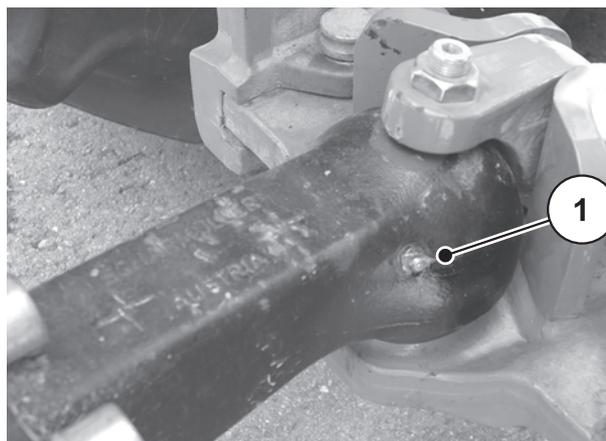
**Рисунок 9.36:** Тягово-сцепное устройство с шаровой головкой
