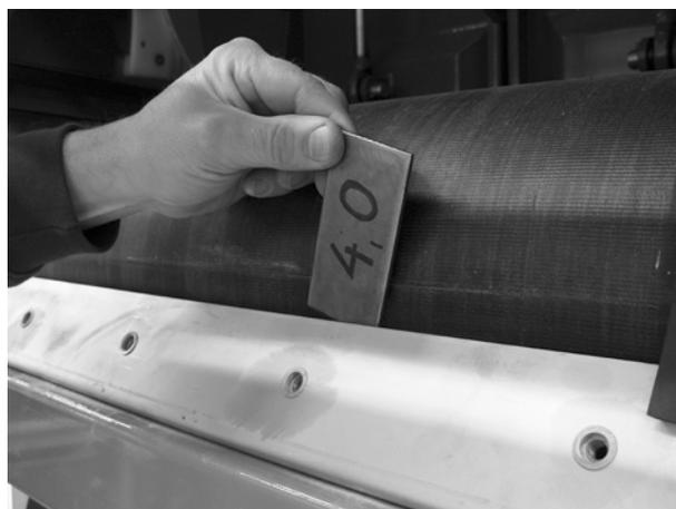
Рисунок 9.21: Проверка расстояния
