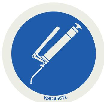
**Рисунок 9.35:** Указатель точки смазки
