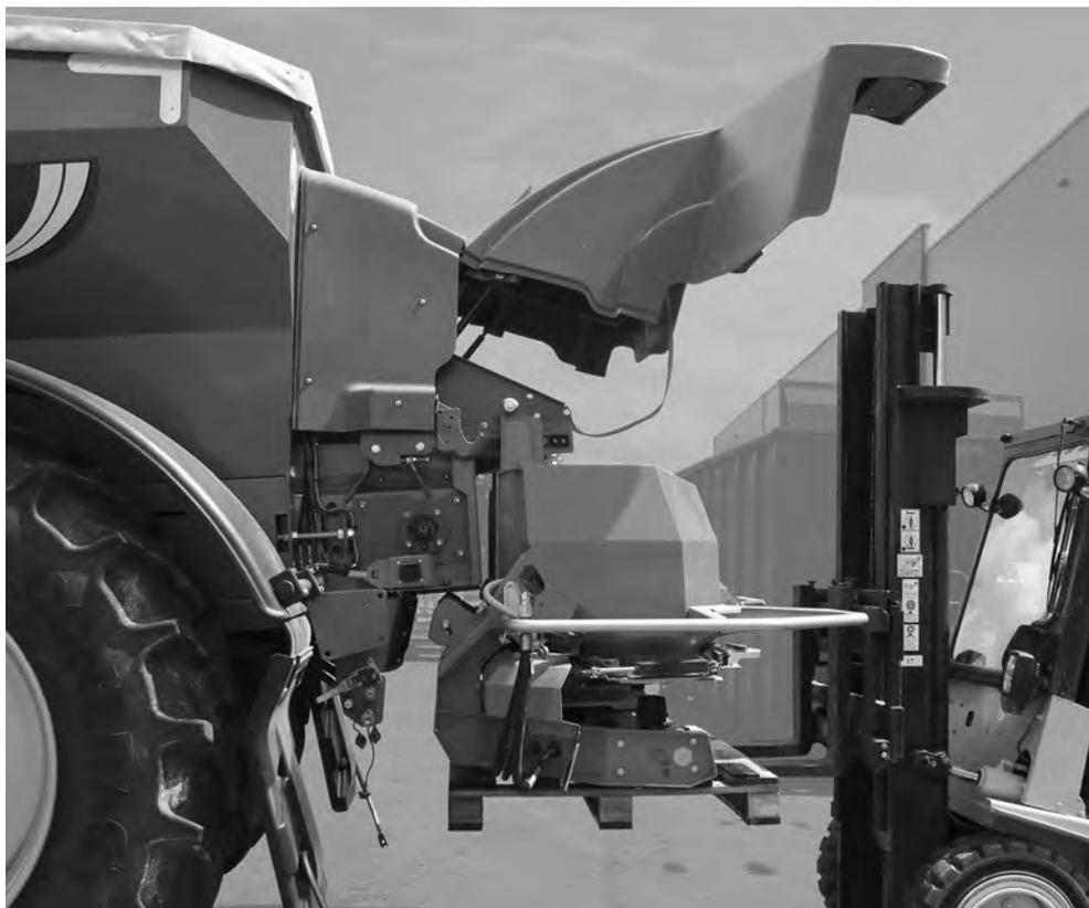
**Рисунок 6.28:** Подвод вилочного погрузчика
