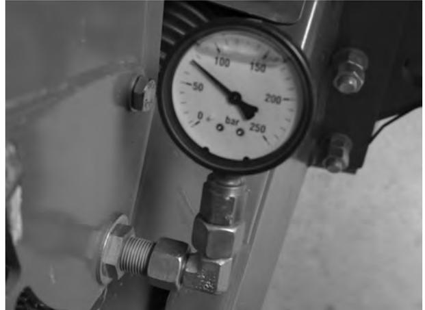
**Рисунок 9.14:** Манометр на кабелепроводе над дышлом
