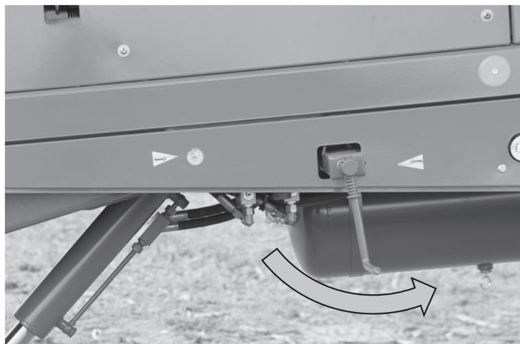
**Рисунок 6.14:** Ручное отпускание стояночного тормоза
