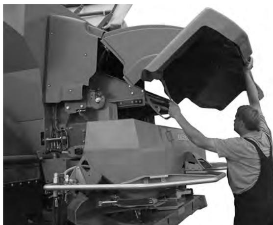
**Рисунок 7.2:** Опускание защитного кожуха за натяжную ленту
