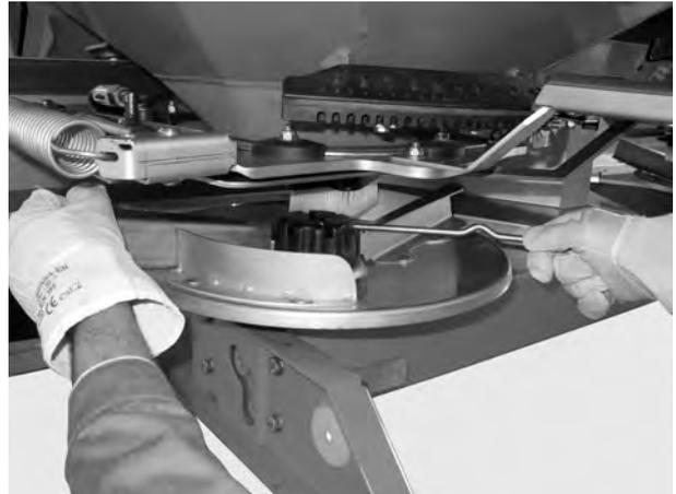
**Рисунок 7.8:** Ослабление колпачковой гайки
