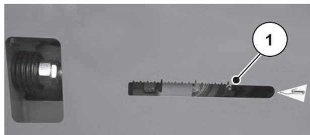
[1] Точка смазки на направляющем ролике
