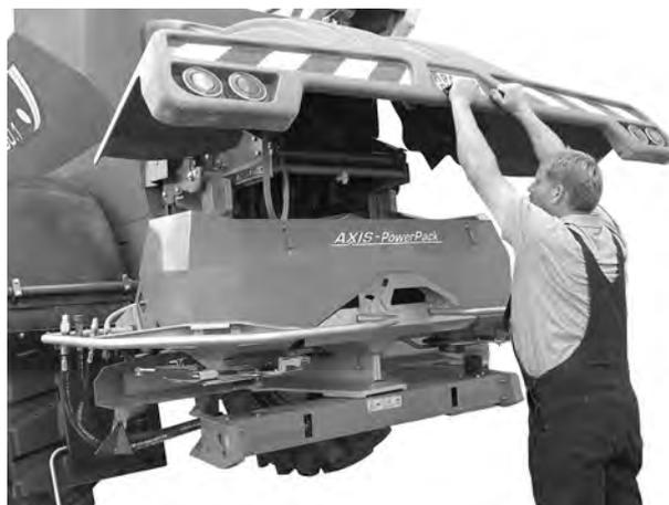
**Рисунок 7.3:** Опускание защитного кожуха за ручки
