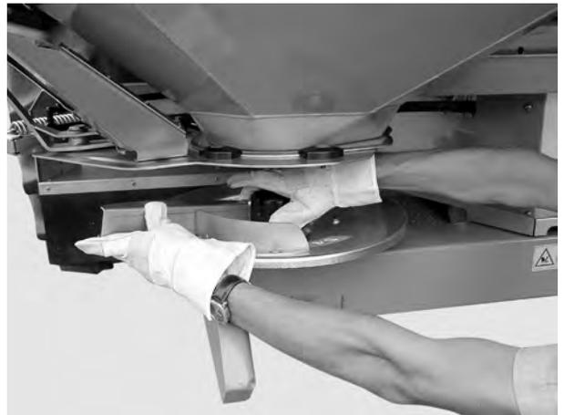
**Рисунок 7.9:** Откручивание колпачковой гайки
