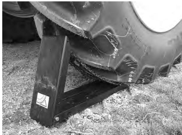
Рисунок 7.23: Размещение противооткатного упора
