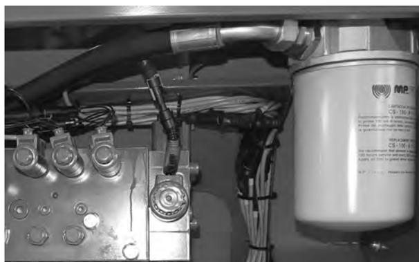
Рисунок 9.27: Масляный фильтр на блоке управления
