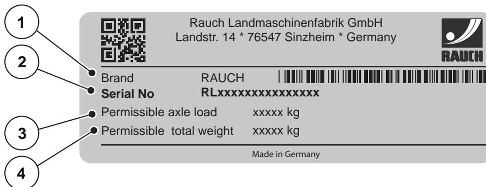
Рисунок 3.7: Вторая заводская табличка для прицепных машин
