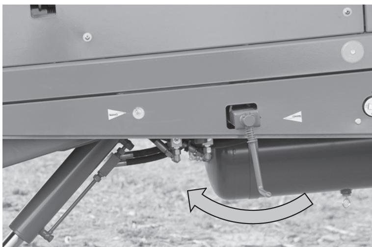
**Рисунок 7.21:** Ручное задействование стояночного тормоза
