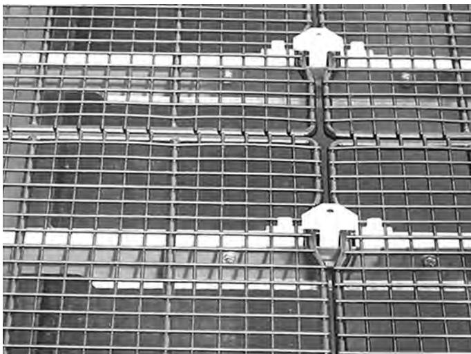
**Рисунок 6.26:** Фиксирование решетки загрузочного отверстия в бункере
