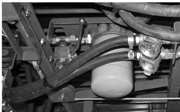
Рисунок 9.28: Масляный фильтр на подрессоренном дышле
