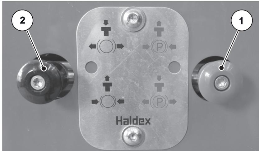
**Рисунок 6.13:** Отпускание стояночного тормоза
