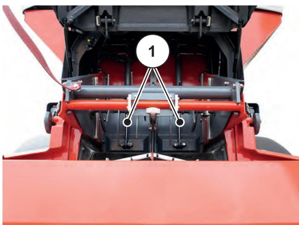
**Рисунок 6.34:** Заслонки устройства предварительного дозирования в закрытом положении
