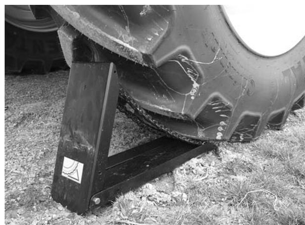
**Bild 7.23:** Unterlegkeil positionieren
