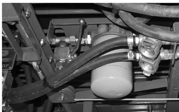
Bild 9.32: Ölfilter Deichselfederung
