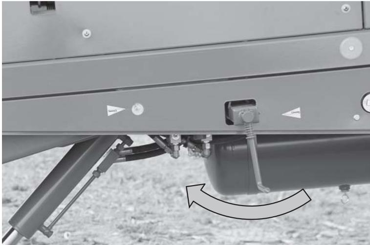
**Bild 7.21:** Manuelle Feststellbremse anziehen
