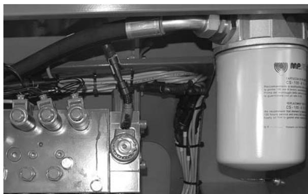
Bild 9.31: Ölfilter Steuerblock
