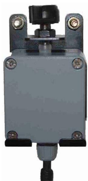
**Bild 6.9:** Gyroskop und Halterung
