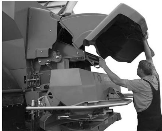
**Bild 7.2:** Zugband ziehen
