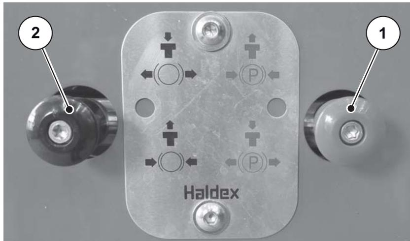
**Bild 6.12:** Feststellbremse lösen
