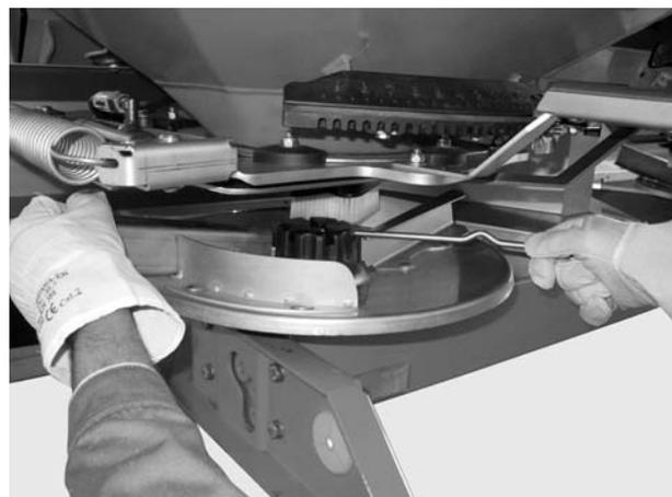
**Bild 7.8:** Hutmutter lösen
