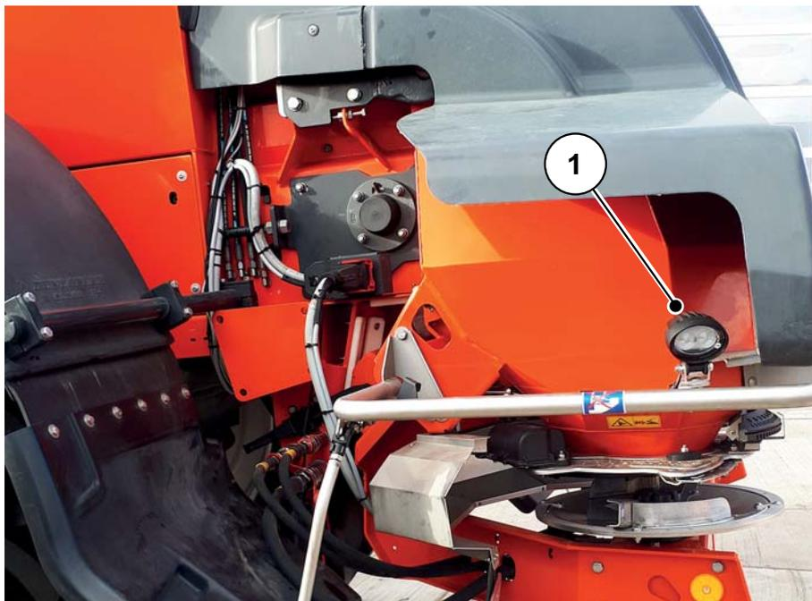
**Bild 4.9:** Sonderausrüstung SpreadLight
