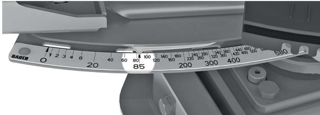
**Bild 7.11:** Skala zur Anzeige der Streumenge
