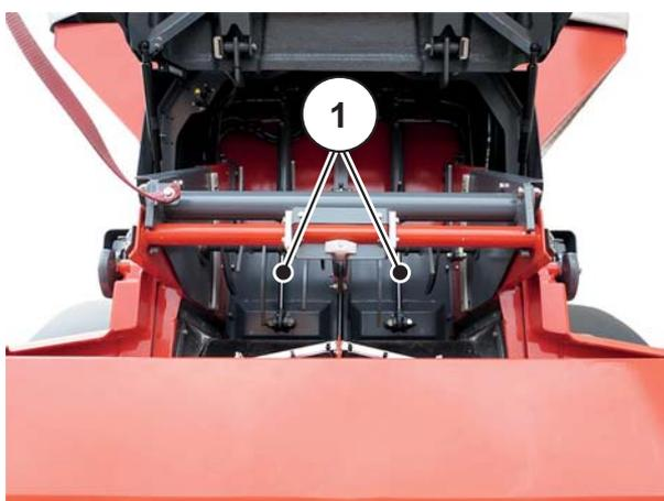
**Bild 6.32:** Vordosierschieber in geschlossener Stellung
