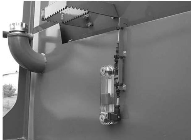
**Bild 9.29:** Lage Ölfüllstandsanzeige
