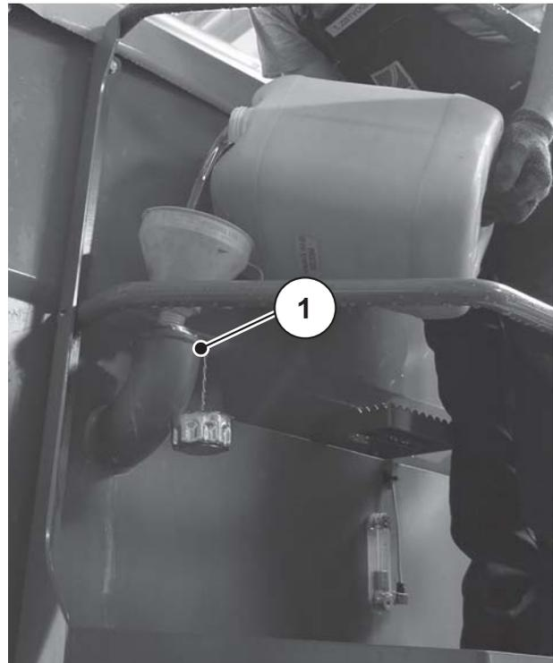
Bild 9.33: Öl einfüllen
