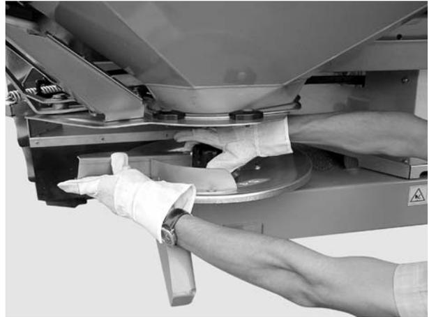
**Bild 7.9:** Hutmutter abschrauben
