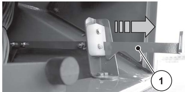
**Bild 9.5:** Hebel der Reinigungsklappe
