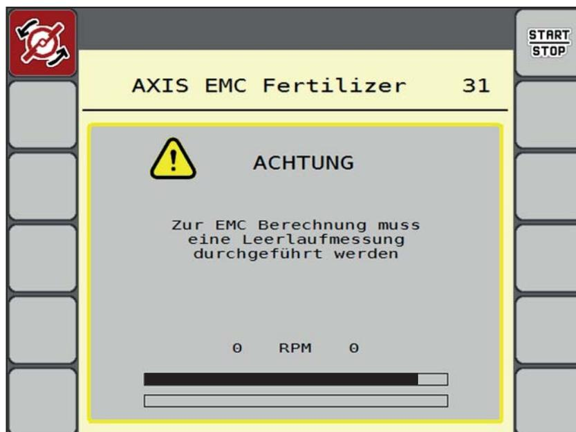
**Bild 5.4:** Alarmanzeige Leerlaufmessung
