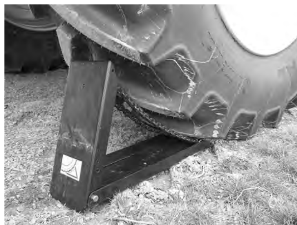
Fig. 55: Poziționarea calei de roată
