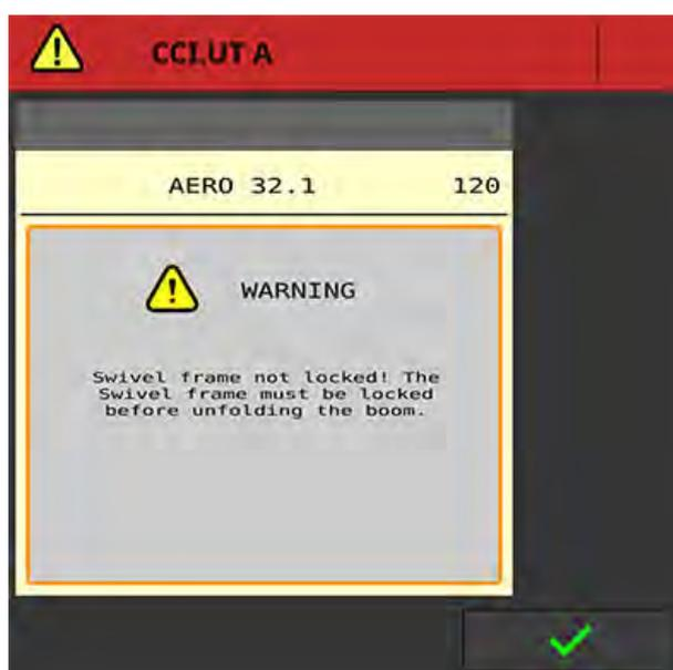
Fig. 12: Message d'alerte verrouillage du châssis pivotant
