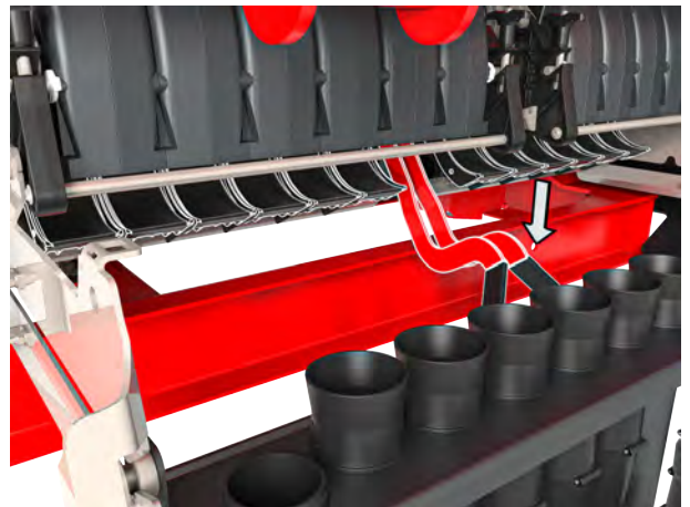
Obr. 35: Odistenie dávkovacej vane
