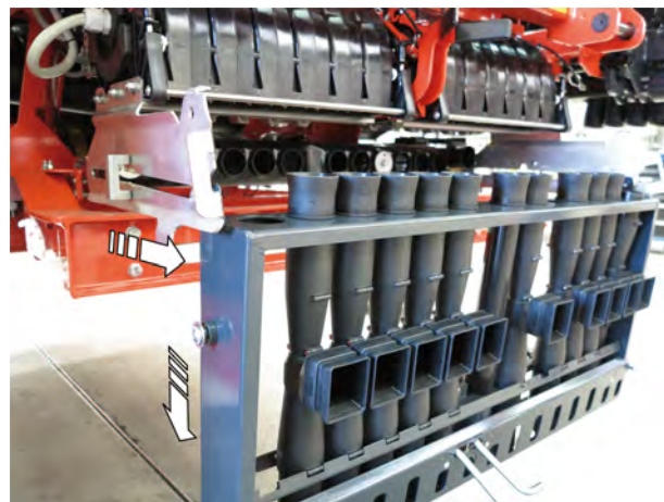
Obr. 51: Spustenie injektorovej kazety nadol
