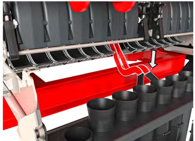
Abb. 52: Verriegelung der Dosierwanne öffnen
