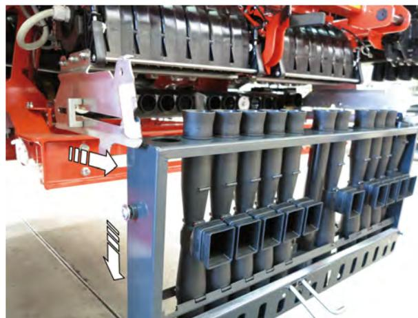
Abb. 32: Injektorkassette ablassen
