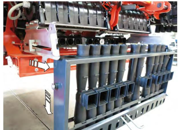
Abb. 51: Injektorkassette ablassen
