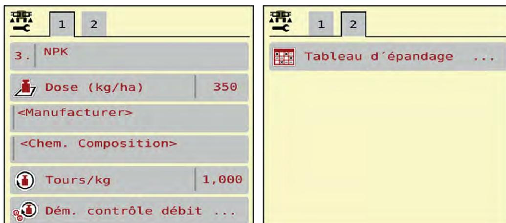
Fig. 6: Menu Réglages engrais, onglets 1 et 2
