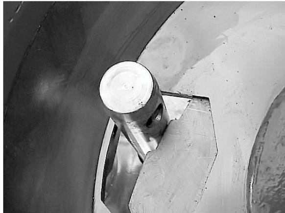
Die Neueinstellung eines Aktuators ist notwendig, wenn sich der Unterlenkerbolzen bei einer Impulszahl von **105 nicht** in die Dosieröffnung stecken lässt, oder wenn der Unterlenkerbolzen **mehr als 1,5 mm** Spiel in der Dosieröffnung hat.
