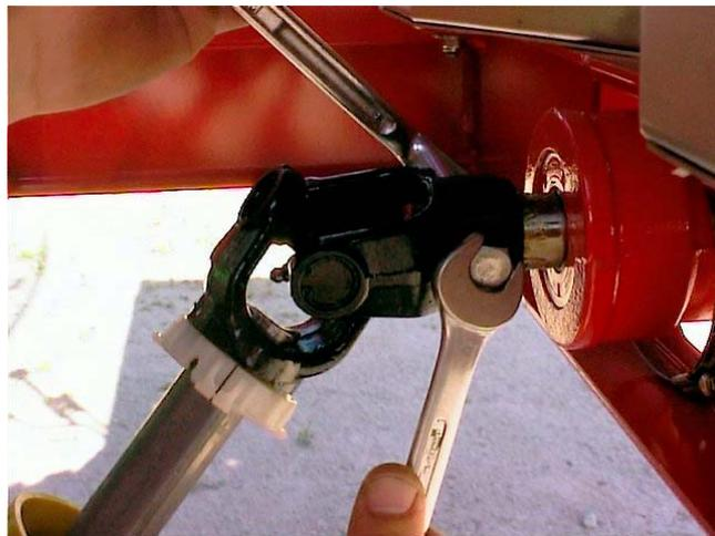
Schutztrichter mit Schlauchschelle über die Gelenkwelle schieben und am Getriebehals anlegen (nicht festziehen)
