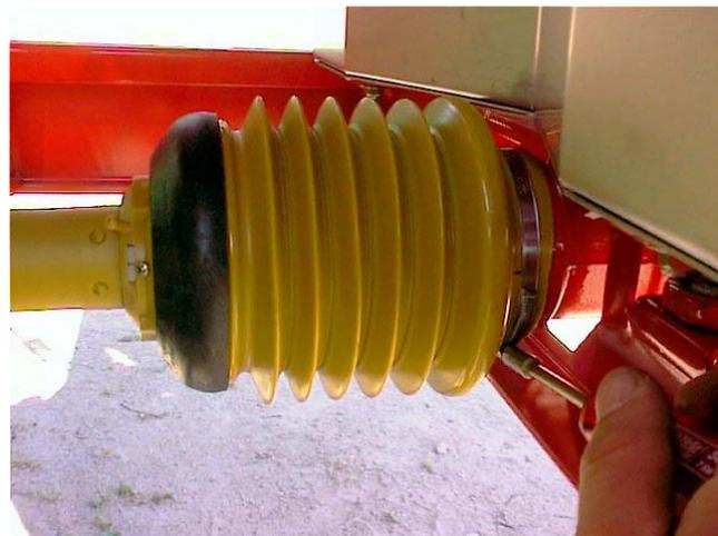
Schutztrichter in die Sperrposition verdrehen.
