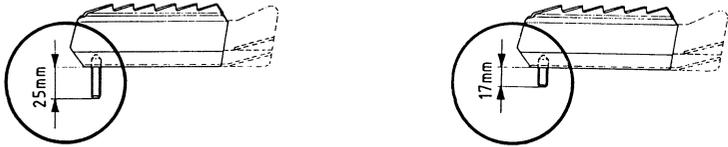
Wurf­flügel mit Gewin­del­länge 25 mm
