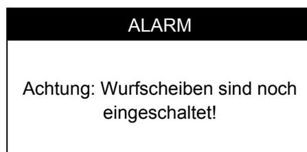
Diese Alarmmeldung erscheint, wenn bei geschlossenen Schiebern und einer Fahrgeschwindigkeit über 15 km/h die Wurfscheiben eingeschaltet sind. Bei einer Fahrgeschwindigkeit unter 15 km/h erlischt die Alarmmeldung wieder. Diese Alarmmeldung wurde aus Sicherheitsgründen eingeführt.
