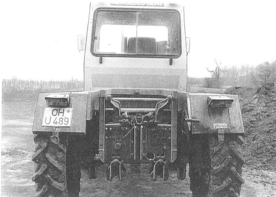
Das 3-Punkt-Gestänge sollte ebenfalls abgebaut werden (Bild 1). Durch das Betätigen des 3-Punktgestänges bei aufgebaumtem Streuer kann, je nach Ausführung der Hubstreben, der Hydrauliktank beschädigt werden.
